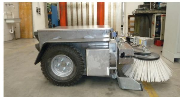
Abbildung 2: Versuchsträger Reinigungsroboter
