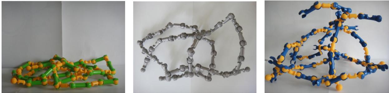
Abb. 1: Modelle je eines Thermoplasten, Elastomers und Duroplasten aus Bausteinen
