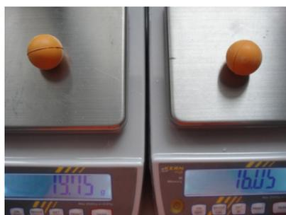
Abb. 2: Zwei Gummibälle im Vergleich: der linke unelastisch, der rechte elastisch
