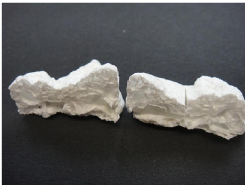
Abb. 7: Wiederaufgeschäumtes Polystyrol im Querschnitt
