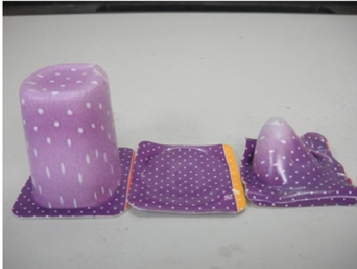
Abb. 3: Joghurtbecher aus Polystyrol, links original, in der Mitte nach dem Erhitzen, rechts nach erneutem Tiefziehen
