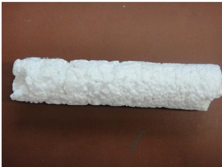
Abb. 5: Aus Styroporstücken durch Erwärmen unter Druck recycelter Styroporblock
