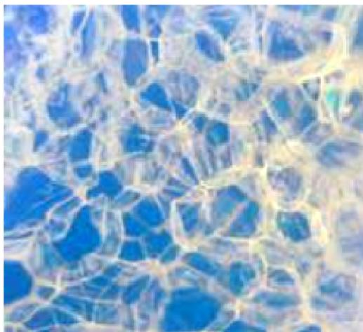
Abb. 4: Styropor in 200-facher Vergrößerung
