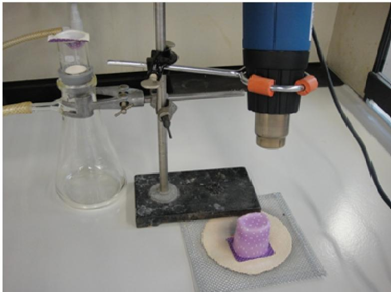
Abb. 2: Versuchsaufbau zum Umschmelzen und Tiefziehen von Polystyrol
