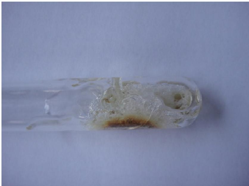
Abb. 2: Reaktionsgemisch aus Glycerin und Citronensäure beim Übergang vom Thermo- zum Duroplasten
