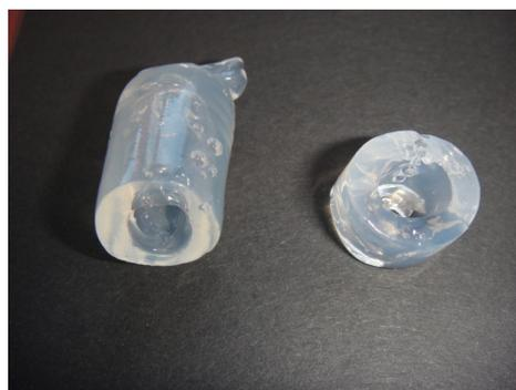
Abb. 4: Röhrenstücke aus Alginatgel nach Dialyse von Alginatmasse in einer  $\text{CaCl}_2$ -Lösung
