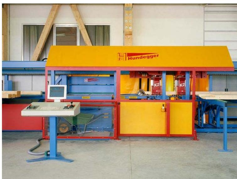
**Bild 3.6: Automatische Abbundanlage vom Typ Hundegger K2 [8]**
