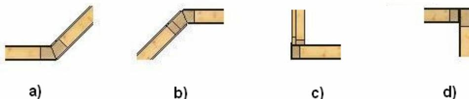
**Bild 7.4: Wandanschlüsse Gebäudemodell 2 – a) Außenecke Turm, b) Innenecke Turm, c) Außenecke Wintergarten, d) Innenecke Wintergarten**
