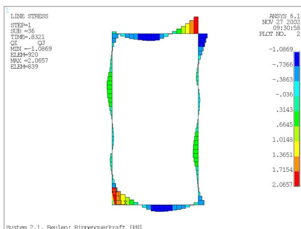
Bild 3-48: Querkraft [kN]
