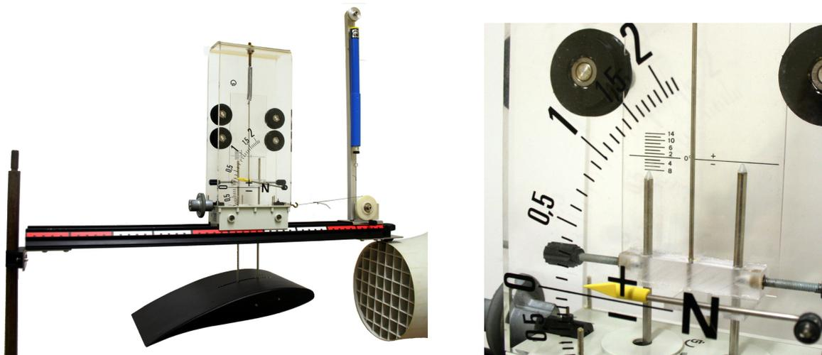
Abb. 3: Versuchsaufbau zur Bestimmung des Strömungswiderstands und des Auftriebs eines Tragflügels (links) und Detailaufnahme des Messwagenaufbaus (rechts). Auf den Skalen des Messwagens können die Auftriebskraft  $F_A$  sowie der durch die Befestigungsstangen vorgegebene Anstellwinkel  $\alpha$  abgelesen werden (hier  $F_A = 0,1 \text{ N}$  und  $\alpha = 8^\circ$ ).
