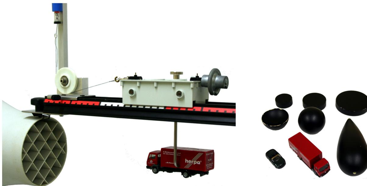
Abb. 2: Versuchsaufbau zur Bestimmung des Strömungswiderstandes (links) und für die Messungen zur Verfügung stehende Probenkörper (rechts). Der hintere Teil der Versuchsschiene ist an einem Stativstab zu befestigen.
