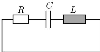
Der fließende Strom  $I(t)$  genügt der Differentialgleichung
