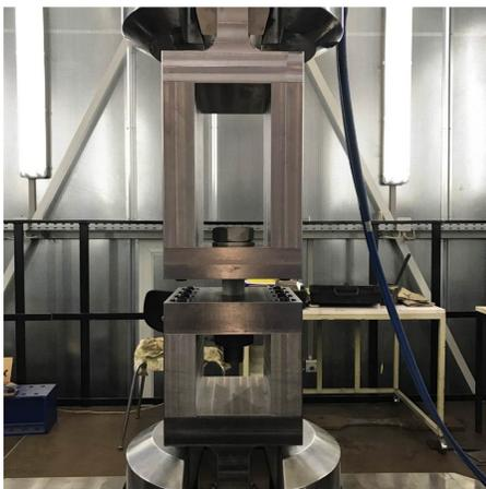
Schwingversuch an 10.9 HV M48 Schraube, 1 MN Hochfrequenzpulsor
