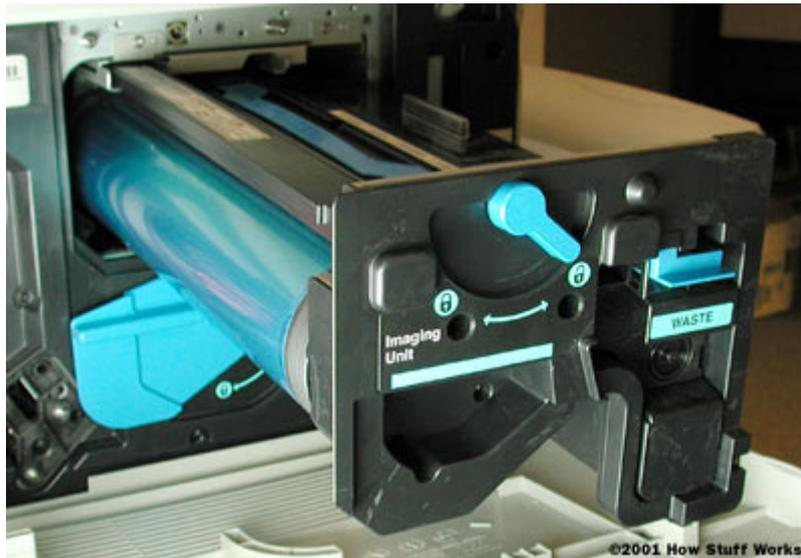
**Abbildung 19: Walze in einem Laserdrucker**
