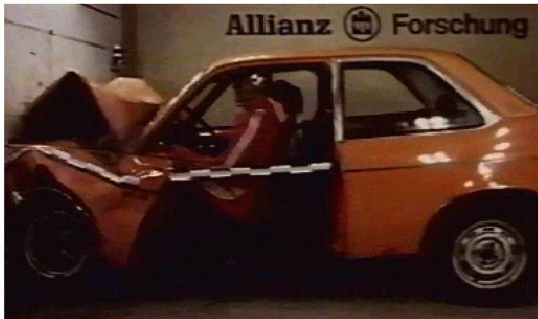
**Abbildung 13: Beim Crashtest wird das Trägheitsgesetz anschaulich**
