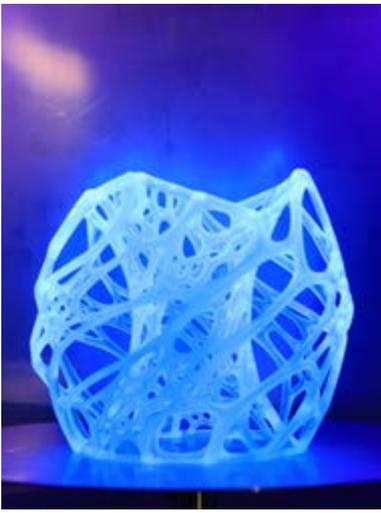
Aushärtung eines am GITZ gedruckten 3D-Objektes unter UV-Licht
