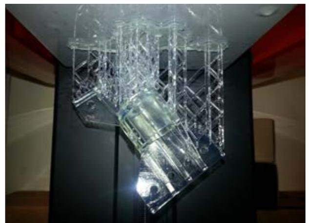
Transparentes Druckobjekt mit notwendigen Stützstellen. Das Objekt füllt die Druckkammer recht gut aus.
