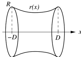
Zwei Kreisringe mit Radius  $R$  und Abstand  $2D$  sind durch eine Seifenhaut verbunden. Die Form  $r(x)$  dieser Haut stellt sich so ein, dass die Oberfläche minimal wird.
