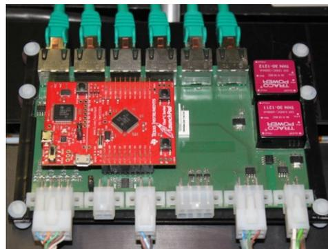
Abb. 4: Zentrale Steuereinheit
