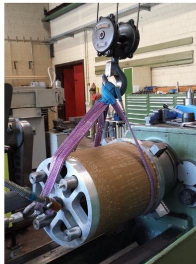
*Prototyp des enersphere Motor / Generators – Werkstatt IMAB*
