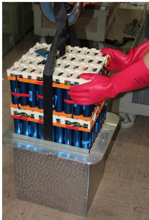
*links: Batteriestack ohne Gehäuse, rechts: Einbau in das Aluminiumgehäuse*
