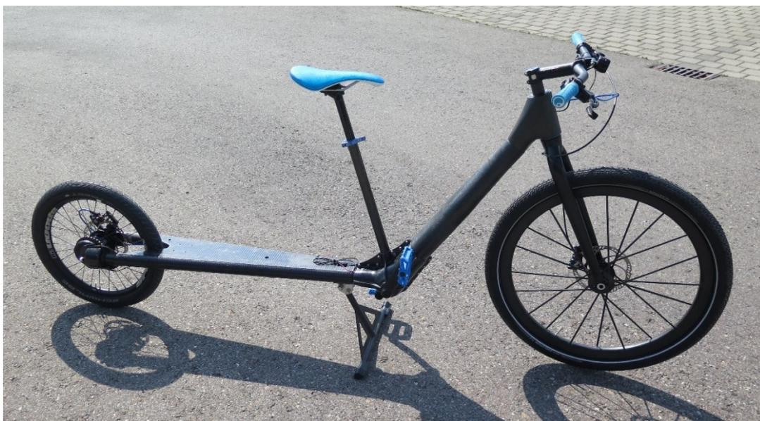
Abb. 9: Aus CFK gefertigte Rahmenstruktur ohne Transportbox vom Projektpartner CarboFibretec. Die Antriebseinheit befindet sich im Unterrohr und ist über ein Getriebe mit dem Tretlagerknoten verbunden.
