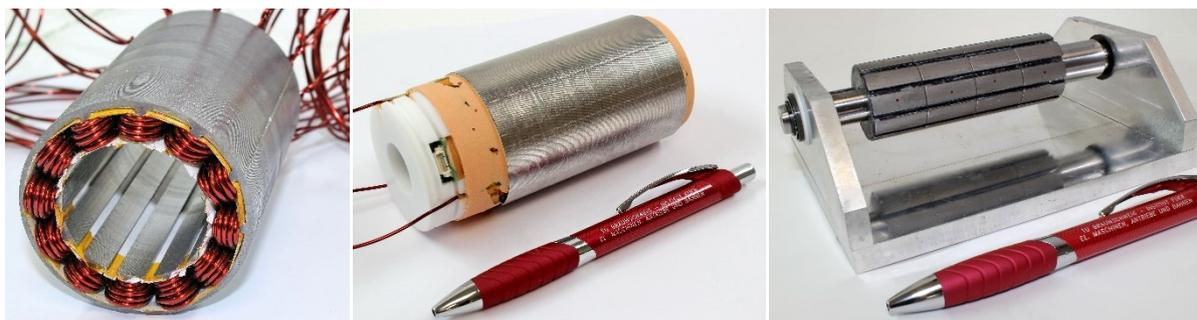
Abb. 10: Einzelne Motorkomponenten während der Fertigung am IMAB. Der bewickelte Stator (l.) wurde mit Sensor vergossen (m.) und wurde mit dem fertigen Rotor (r.) in das speziell entwickelte Gehäuse gefügt.
