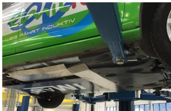
*Induktivempfänger am Fahrzeugunterboden (schwarz mit Institutschriftzug) und Unterbodenschutz aus Aluminiumblech*
