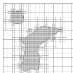
Kopplung von hierarchisch strukturierten Lattice-Boltzmann-Rechengittern
