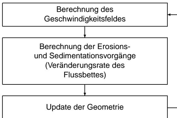
Flussdiagramm zur Kolkvorhersage mit numerischen Modellen
