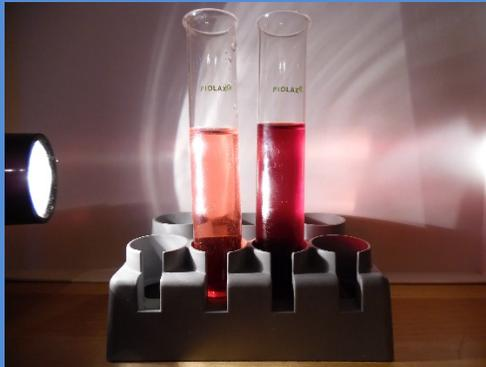
Photometer gibt es in unterschiedlichen Ausführungen. Sie bestehen im Wesentlichen aus einer Lichtquelle, ggf. einem Monochromator, der Probe und einem Lichtdetektor. Dieses Prinzip wird in dieser Experimentreihe in einem einfachen Aufbau realisiert und die Funktion des Photometers anschließend erprobt.
