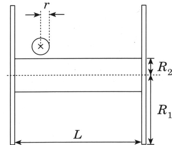
► *Wie viel Meter Kabel passen auf diese Kabeltrommel?*
