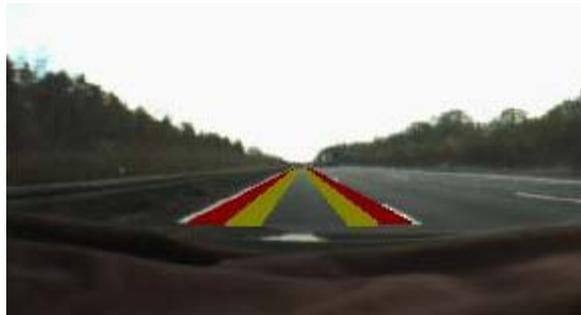
Abbildung 2-6 Illustration der Warn-Bereiche der Querführungsassistenten innerhalb der Fahrspur. Der unsichere Bereich ist gelb hinterlegt, der kritische Bereich rot hinterlegt
