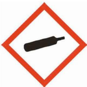
Die so gekennzeichneten Gebinde müssen mit dem Signalwort „Achtung“ ergänzt werden. Sie können folgende Gase enthalten:
