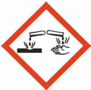
Die so gekennzeichneten Gebinde müssen mit dem Signalwort „Gefahr“ ergänzt werden. Sie können folgende Stoffe enthalten:
