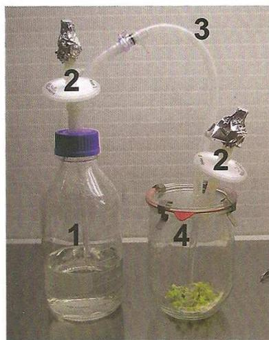
Abb. 1: Grundeinheit des Temporary Immersion System (TIS), 1 = Gefäß für das Nährmedium, 2 = Druckluftzufuhr mit Sterilfilter, 3 = Verbindungsschlauch für Transport von Nährmedium, 4 = Kulturgefäß mit Pflanzenmaterial.
