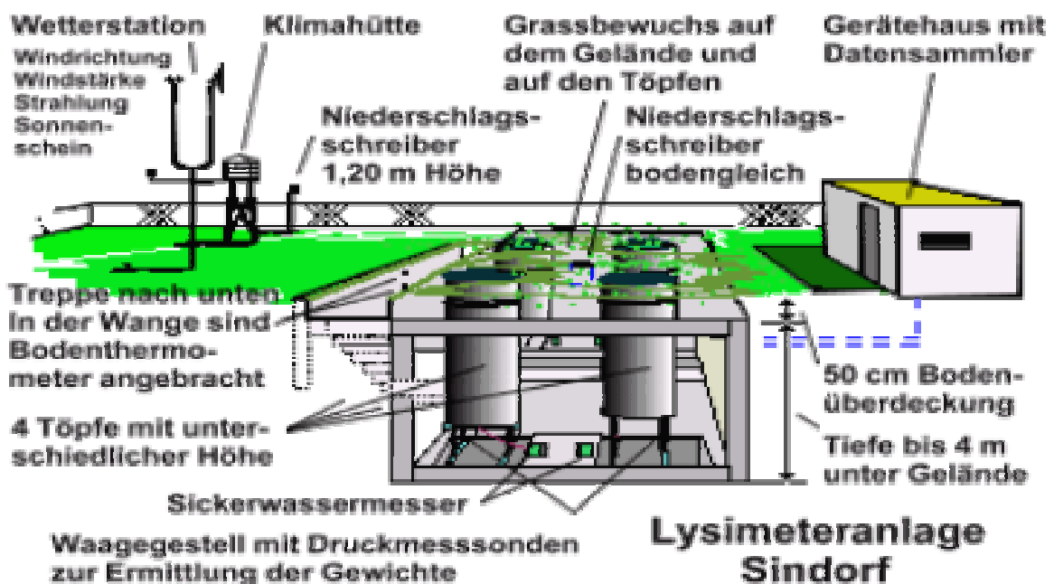
Fig. 4: Lysimeteranlage Sindorf (Quelle: Umweltamt Köln)
