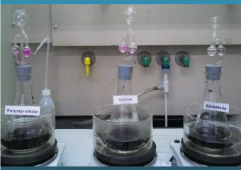
Indirekter Nachweis von CO<sub>2</sub> als Produkt der Kompostierung von Polymerfolien: Phenolphthalein wird infolge pH-Absenkung entfärbt.
