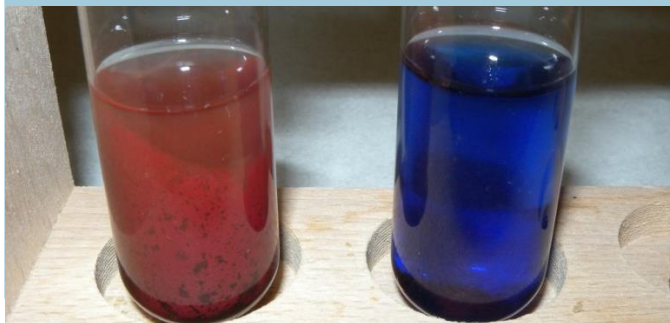
Nachweis von Glucose mit Fehlings Reagenz nach Stärkehydrolyse. Links: positiv, rechts negativ
