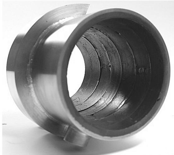
**Bild 2:** Stator eines zylindrischen HTSL-Magnetlagers
