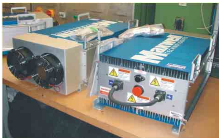
Bild 7: Maxwell HTM Power Modul 125 V, 63 F
