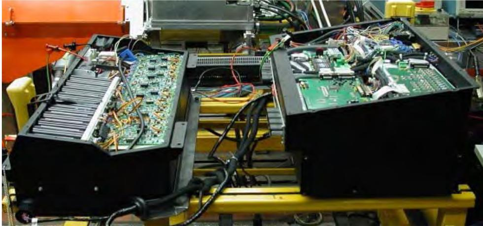
**Bild 5:** 2 Superkondensatorblöcke mit 140 Einheiten in einem VW Bora liefern eine konstante Leistung von 50 kW über 15 s
