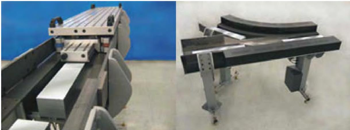
**Bild 2:** Das System MagneMover der Firma MagneMotion. Links das Fahrzeug über dem modularen Langstator, rechts ein Weichenmodul [2]
