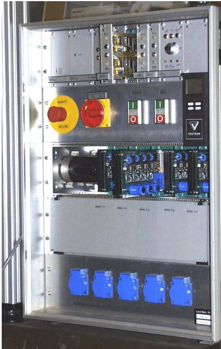
Abb. 3: Schrank mit Stellern und Frequenzumrichter
