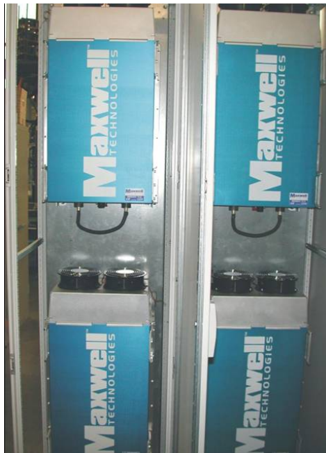
Bild 5: Laboraufbau, bestehend aus Superkondensatormodul 16 F/ 500V (links) und bidirektionalem Hoch-Tiefsetzsteller (rechts)
