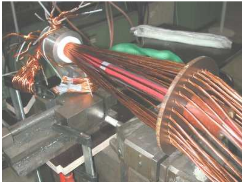
Bild 7: Herstellung eines Labormusters für ein Leistungs-Koaxialkabel für hohe Frequenzen am IMAB
