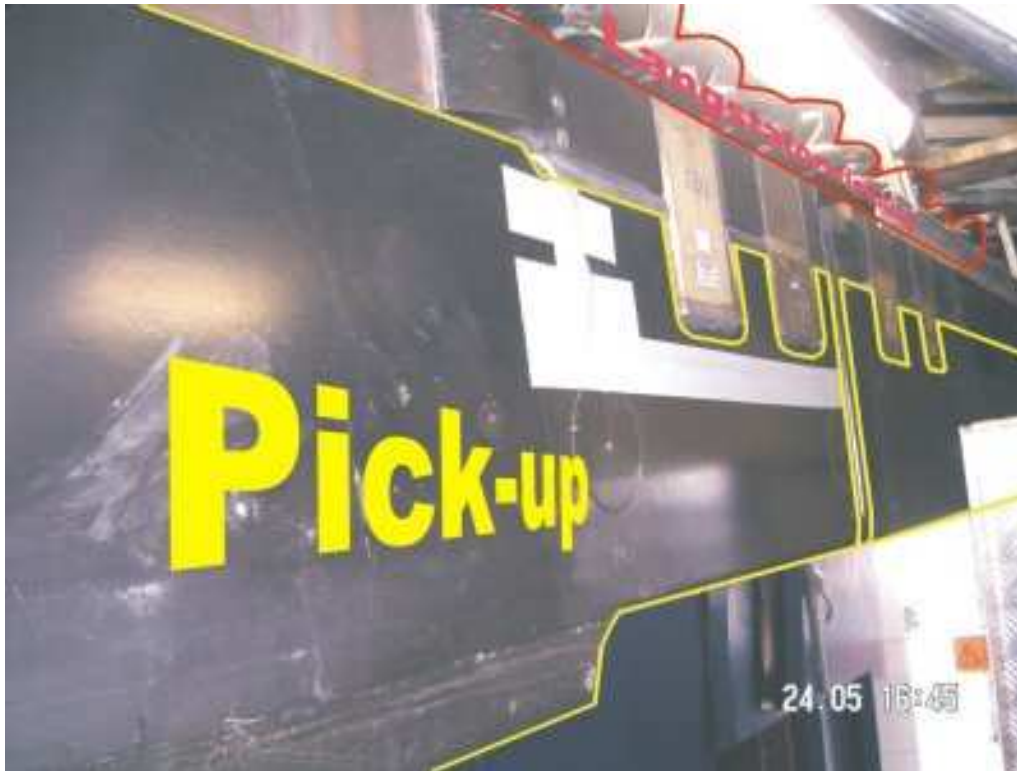
Bild 4: Blick unter das Transrapidfahrzeug auf die mit Pick-ups ausgerüstete Verkleidungsstruktur
