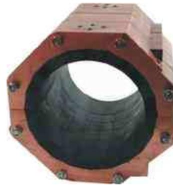
**Bild 9:** Lagerschalen eines supraleitenden Lagers, bestehend aus einzelnen HTSL-Formkörpern und einer Kupfereinfassung, welche innerhalb des Dewar als Kaltkopf dient
