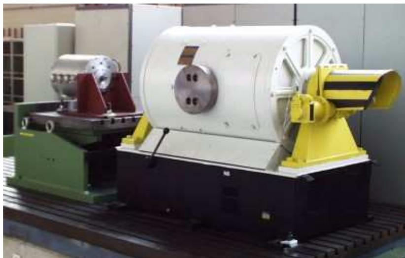
**Bild 1: Pendelmaschine (rechts) und Prüfling**
