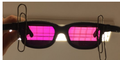
Abb. 9 Licht einer weißen Lampe erscheint beim Durchgang durch zwei Brillen magenta. Die beiden Brillen werden durch Büroklammern zusammengehalten.
