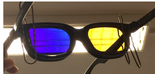
Abb. 16 Nach dem Kippen ist das Licht der weißen Lampe in einem Brillenglas blau und im anderen gelb gefärbt.
