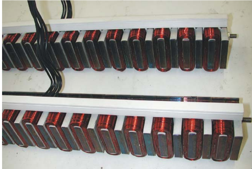
Bild 8: Statormodule für den Beschleunigungsabschnitt
