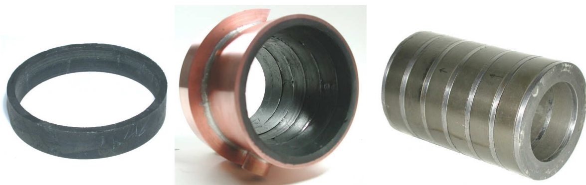
Bild 4: HTSL-Ring (links), Lagerstator (mitte), Erregersystem (rechts)
