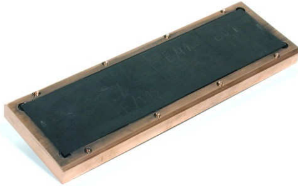
Bild 2: Vier YBaCuO-Proben mit Kupferrahmen zur Befestigung auf dem Kaltkopf
