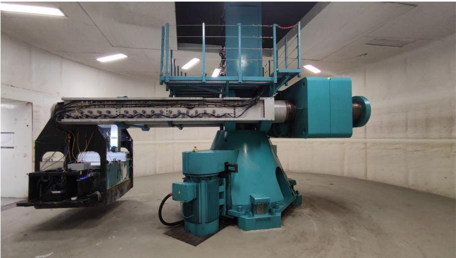
**Abbildung 5 Geotechnische Zentrifuge C72 am COFS der UWA**
