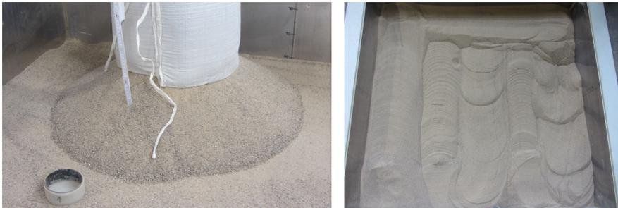
**Abbildung 8: Einbau des Sandes,**
