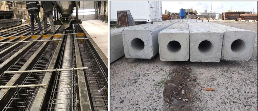
**Abbildung 17: Fertigbetonrammpfahl mit Innenschalung**
