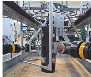
**Abbildung 3. Versuchsaufbau bei einem multidirektionalen Versuch**
