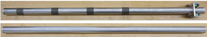
**Abbildung 3: Foto des Modellpfahls, oben: instrumentierte Variante (Messpfahl), unten: nicht instrumentierte Variante**
