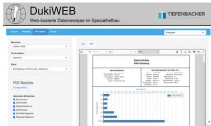
**Abbildung 6: Datenaustausch zwischen Prozessdatenerfassung und Web-Applikation**
