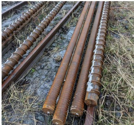
**Abbildung 12: Stahlzugglieder in Stahlgüte ASDO 500 mit Wendel (rechts, links) und mit Rippung (mittig) zur Kraftübertragung.**
