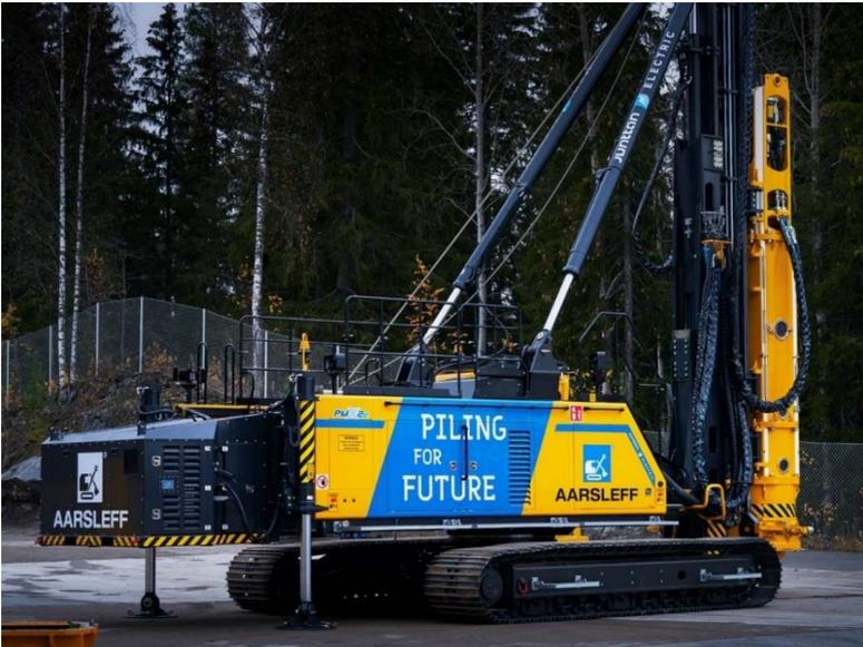
Abbildung 19: Elektrische Rammanlage Junttan PMx2e
