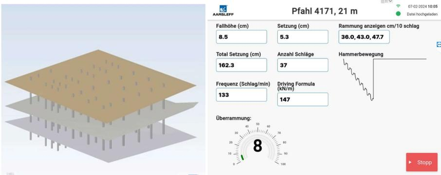
**Abbildung 12: Baugrundmodell und Steuerung der Pfahleinbringung**
