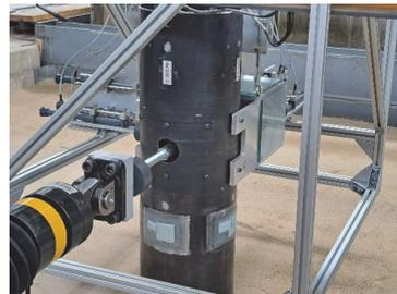
**Abbildung 2. Versuchsaufbau bei einem monodirektionalen Versuch**
