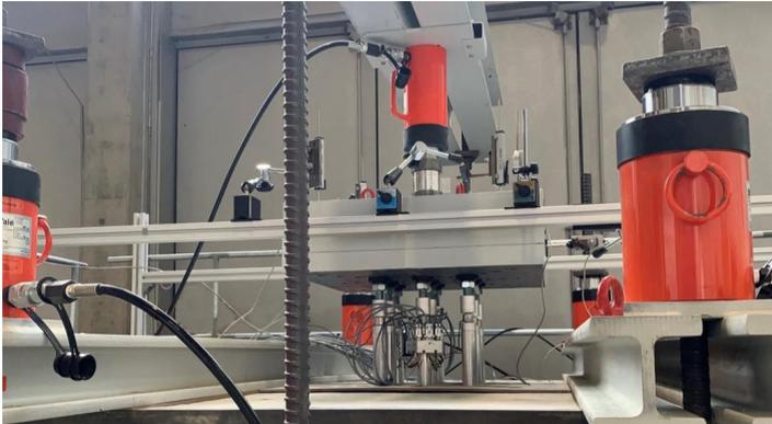
**Abbildung 5: Statische Probelastung an der 3 x 3 Verdrängungspfahlgruppe mit 3·D Pfahlachsabstand in der IGS Calibration Chamber**
