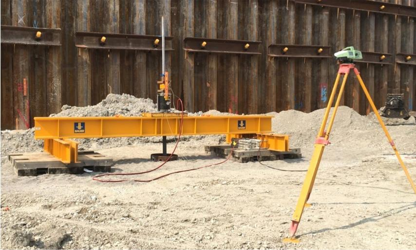
Abbildung 6: Prüfaufbau und Messtechnik mit oberhalb der Spannpresse angeordneter Nivellierlatte
