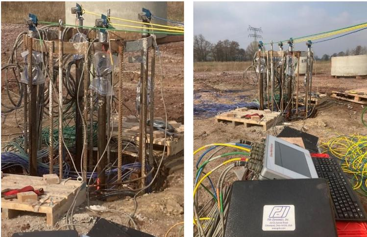
**Abbildung 6: Ultraschall-Integritätsprüfung am Probestpfahl**
