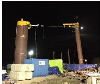
Abbildung 11: Möglichkeiten zur horizontalen Versuchslastaufbringung bei Grossbohrpfählen (links) und Monopfählen (rechts)
