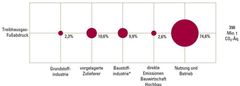
**Abbildung 1: Treibhausgas-Fußabdruck des Handlungsfelds „Errichtung und Nutzung von Hochbauten“ im Jahr 2014 [BBSR, 2020]**
