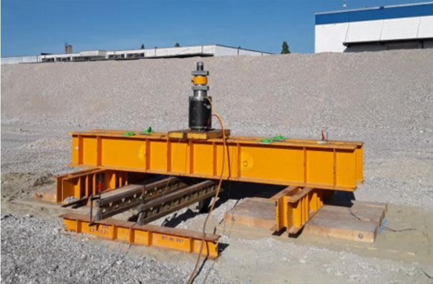
**Abbildung 4: Standard-Aufbau Reaktionssystem mit Zentrierträger zur planmäßigen Lasteinleitung**
