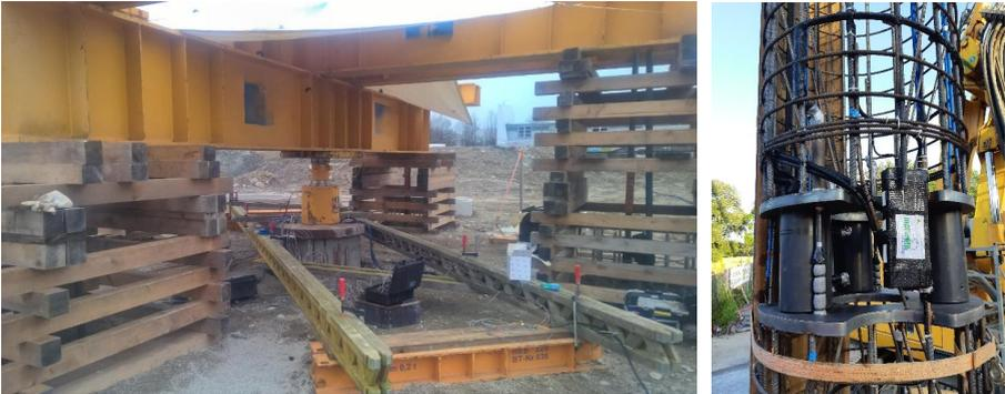
**Abbildung 7: Möglichkeiten zur Lastaufbringung bei Pfahlbelastungsversuchen (links Last auf Pfahlkopf, rechts bidirektional)**
