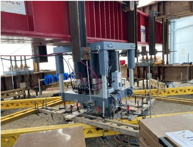
**Abbildung 21: Belastungseinrichtung, Pressenpaket und Referenzsystem**
