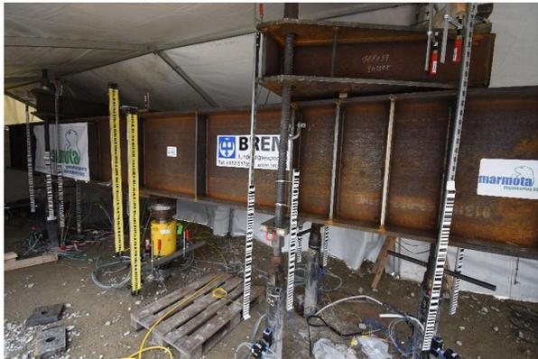
Abbildung 4: Instrumentierung Zugpfahl mit faseroptischem Dehnungssensor (links), Mikropfahlbelastungsversuch (rechts)
