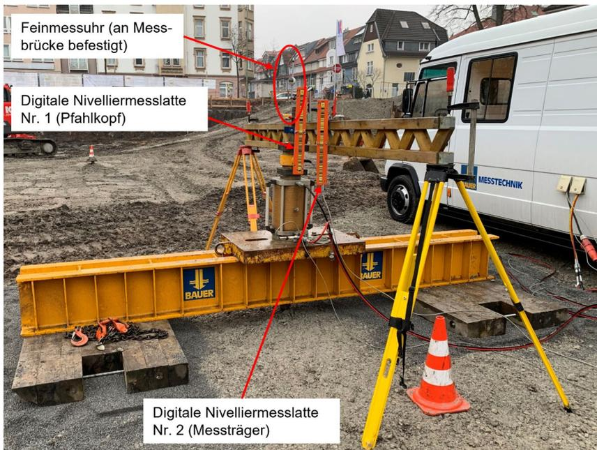
**Abbildung 3: Reaktionssystem auf Tragschicht und Feinplanum, zusätzliche Verformungsmessung des Messträgers**
