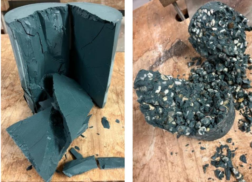
**Abbildung 13: Bruchverhalten infolge einaxialer Druckbelastung: links Dichtwandmasse, rechts Kies mit Dichtwandmasse injiziert**
