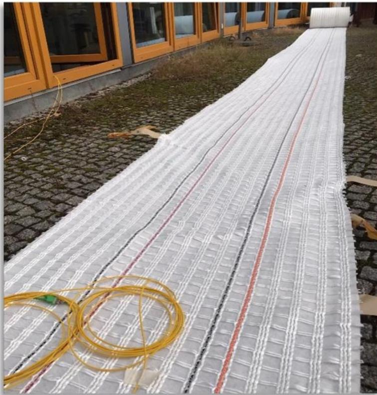
**Abbildung 9: Geogitter mit integrierten faseroptischen Sensorkabeln (Hersteller Huesker)**
