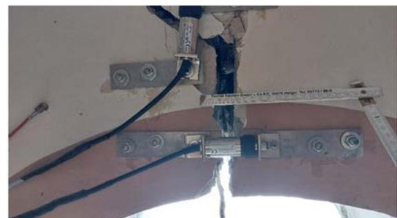
**Abbildung 4: Positionierung der Messwertaufnehmer und Montagebeispiele**
