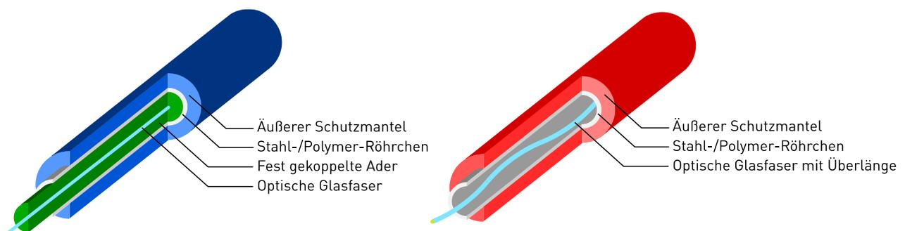
**Abbildung 6: Faseroptische Sensorkabel für die Messung von Dehnung (links) und Temperatur (rechts)**
