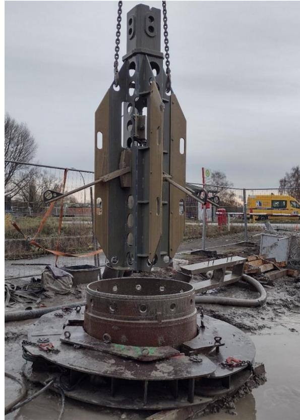
**Abbildung 9: Pfählspektor vor und nach der Messfahrt mittels Seilbagger (Quelle: BBI)**
