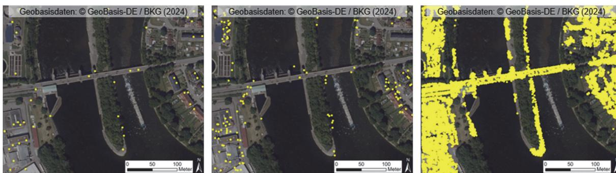
**Abbildung 7: Messpunkte in LOS im Untersuchungsgebiet (ca. 400 x 350 m) bei einer einheitlichen Kohärenzschwelle von 0,75 (links: BBD, Mitte: EGMS, rechts: SqueeSAR® (Datengrundlage: TerraSAR-X HS-Mode), Geobasisdaten: © GeoBasis-DE / BKG (2024))**
