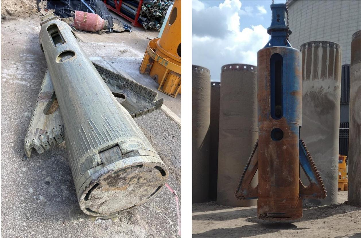
**Abbildung 1: Pfahlfußaufschneider für Bohrpfähle 0,9 m und 1,2 m (Quellen: DEGES, BBI)**
