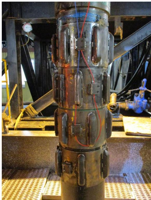
**Abbildung 12: Instrumentierung der Verrohrung des Bohrlochs mit Temperatur- und Dehnungssensorkabeln: Schema (links), Befestigung an den Centralizern (rechts).**
