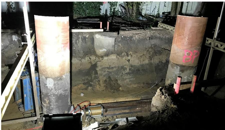
**Bild 14: H-Lastversuch an Bohrpfählen in Hamburg Altona (Quelle: Porr Spezialtiefbau GmbH)**
