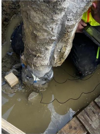
(b) Einbau der Kraftmessdosen an die Grundplatten
