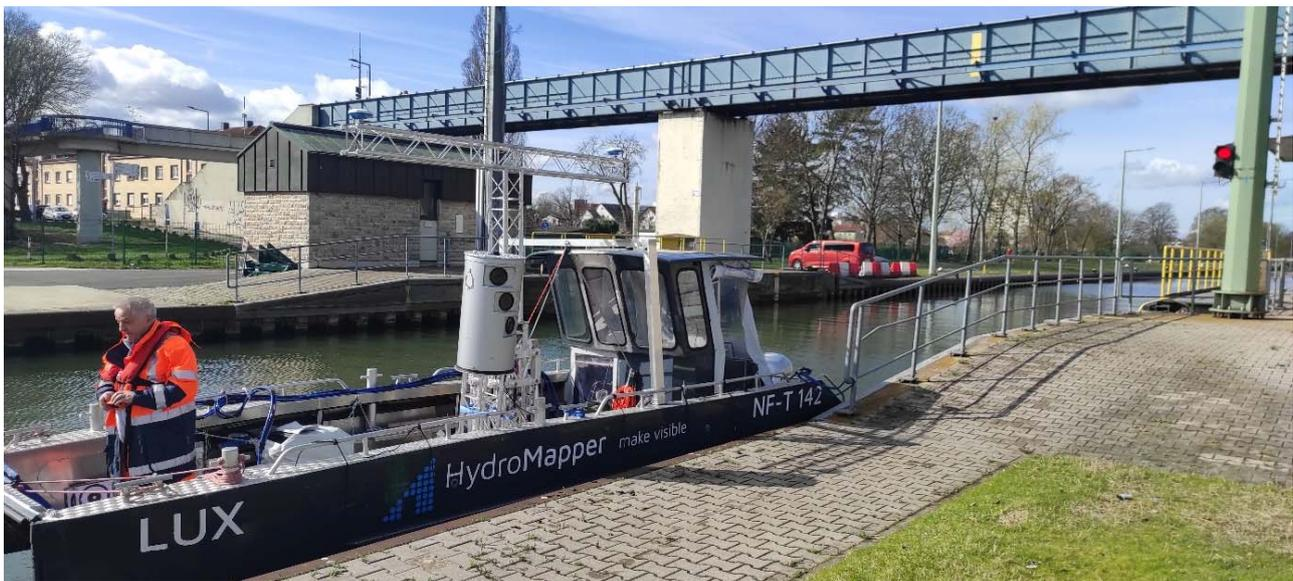
**Abb. 10: HD Mapping-System auf Messboot „LUX“**
