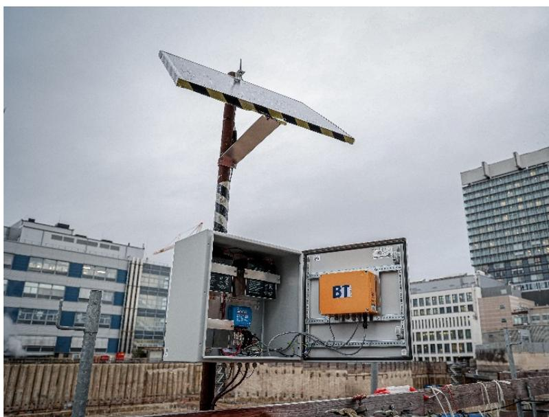
**Abbildung 12:        IoT- Device zur Übertragung der Daten in die Cloud**
