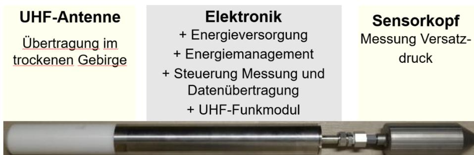
Bild 4: Gesamtansicht Druckaufnehmer mit kabelloser Datenübertragung
