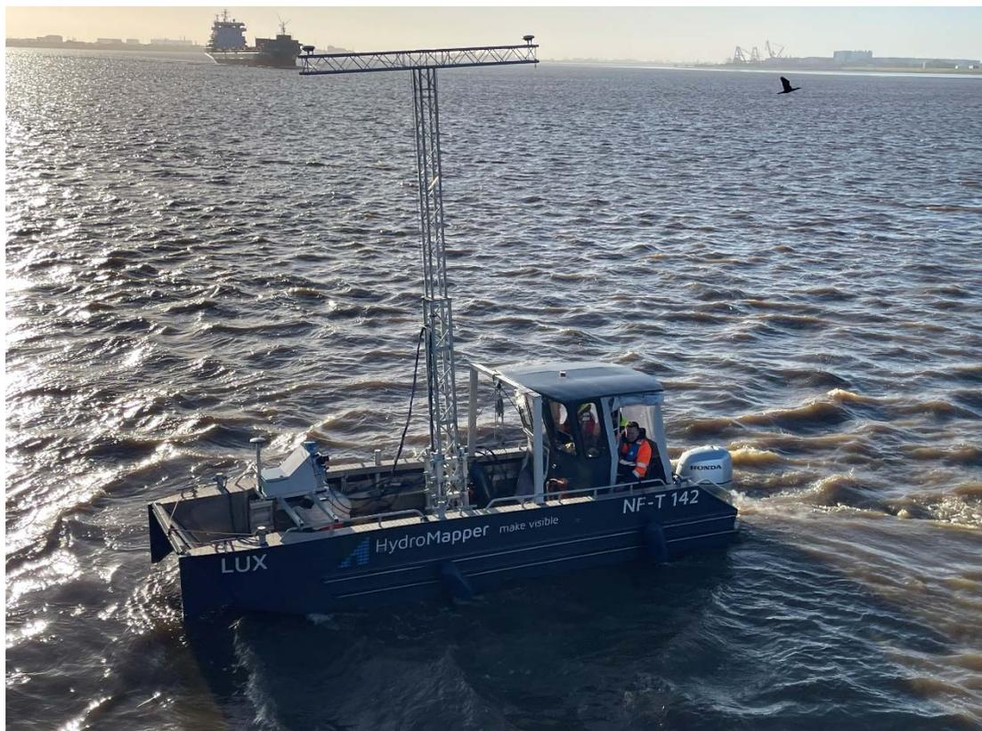
**Abb. 6:** Laserscan und Multibeamsystem im Einsatz auf der Außenweser
