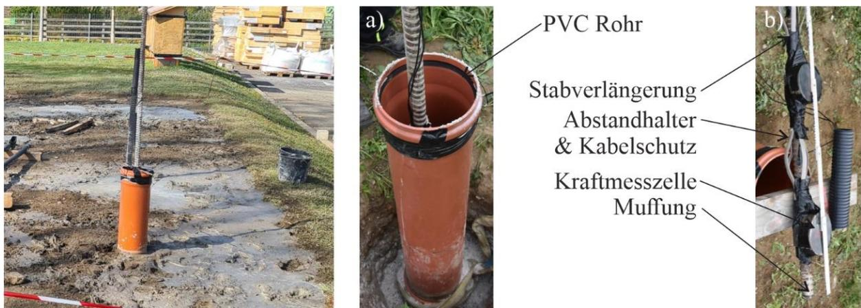
**Abbildung 5: Versuchsaufbau Mikropfahl**
