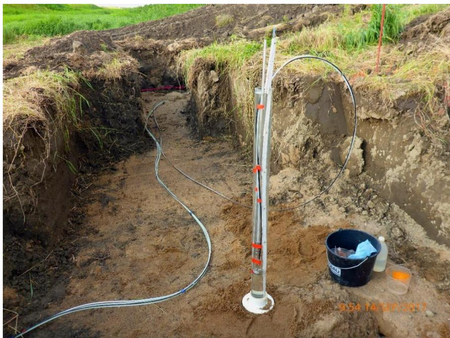
**Abbildung 11: Standrohr mit eingehängtem Porenwasserdruckmessgeber zum Nachweis der Funktionstüchtigkeit unmittelbar vor Abdeckung des Messgebers**
