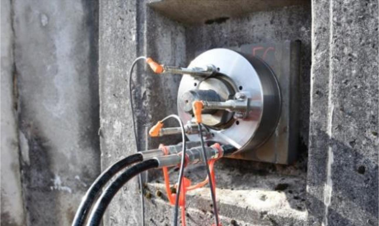
**Abbildung 8: Prüfgerät zur Abhebekontrolle**
