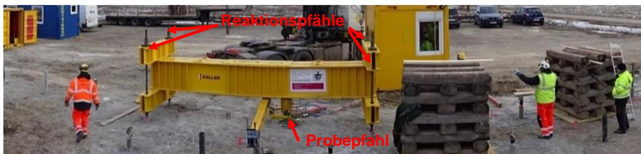
**Abbildung 2: Duktilpfahlprüfung (Druck) mittels Reaktionspfählen**
