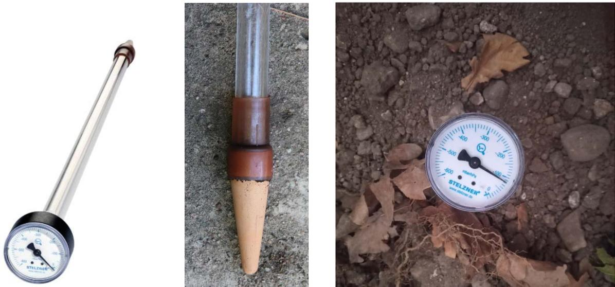
**Abbildung 5: Tensiometer, Tonzelle und Einbausituation**
