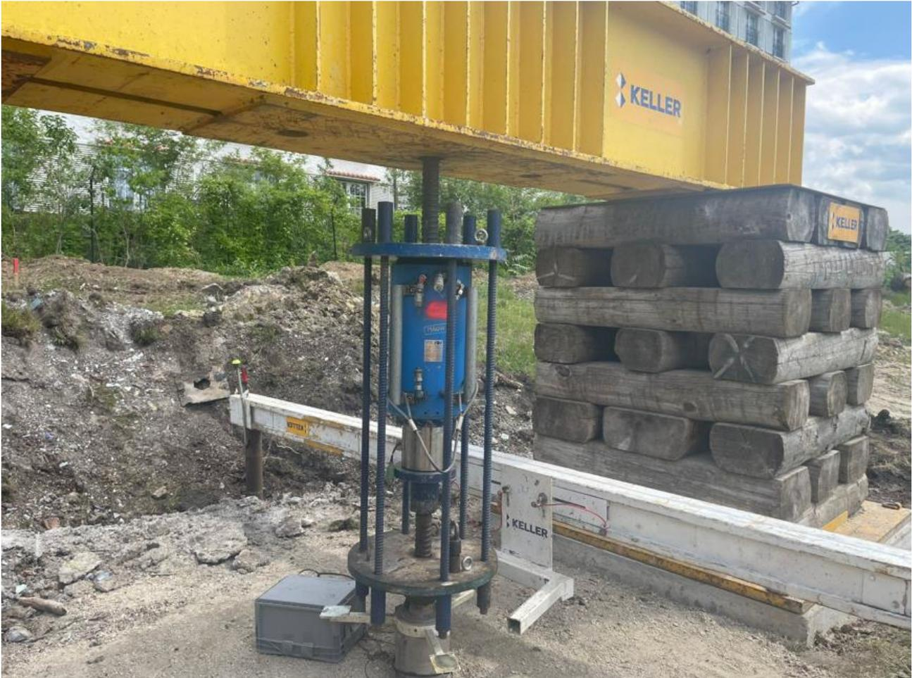
**Abbildung 9: Versuchsaufbau des Prüfpfahles inklusive Messeinrichtungen**
