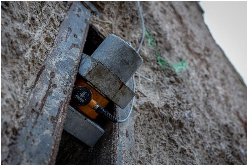
**Abbildung 11:        Eingebaute digitale Kraftmessdose (BAUER Load Cell - BLC)**
