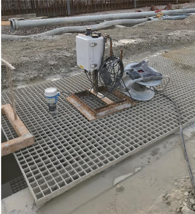
**Abbildung 6: Einbausituation am Schlitz. Sensorkopf (links) mit Übertragungseinheit (rechts)**
