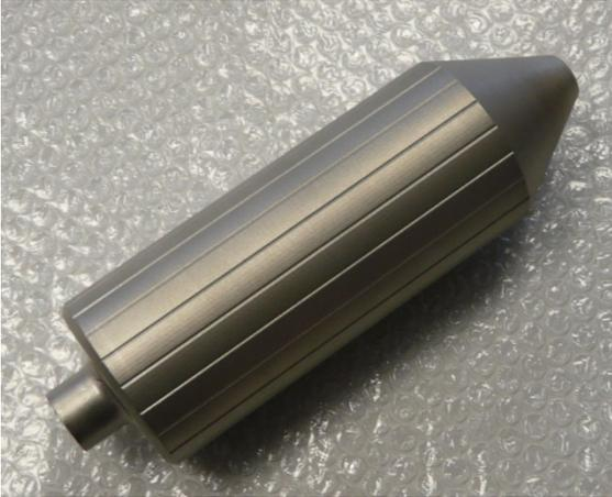
Bild 3: Ansicht des Sensorkopfes nach dem 3D-Druck
