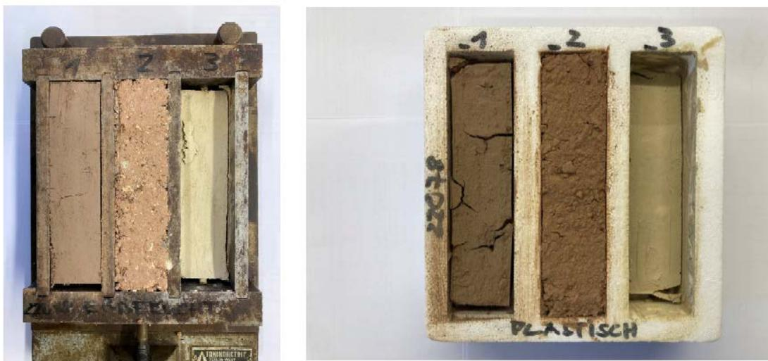
Abbildung 9: Bestimmung der Schwindmaße (erdfeucht / plastisch)
