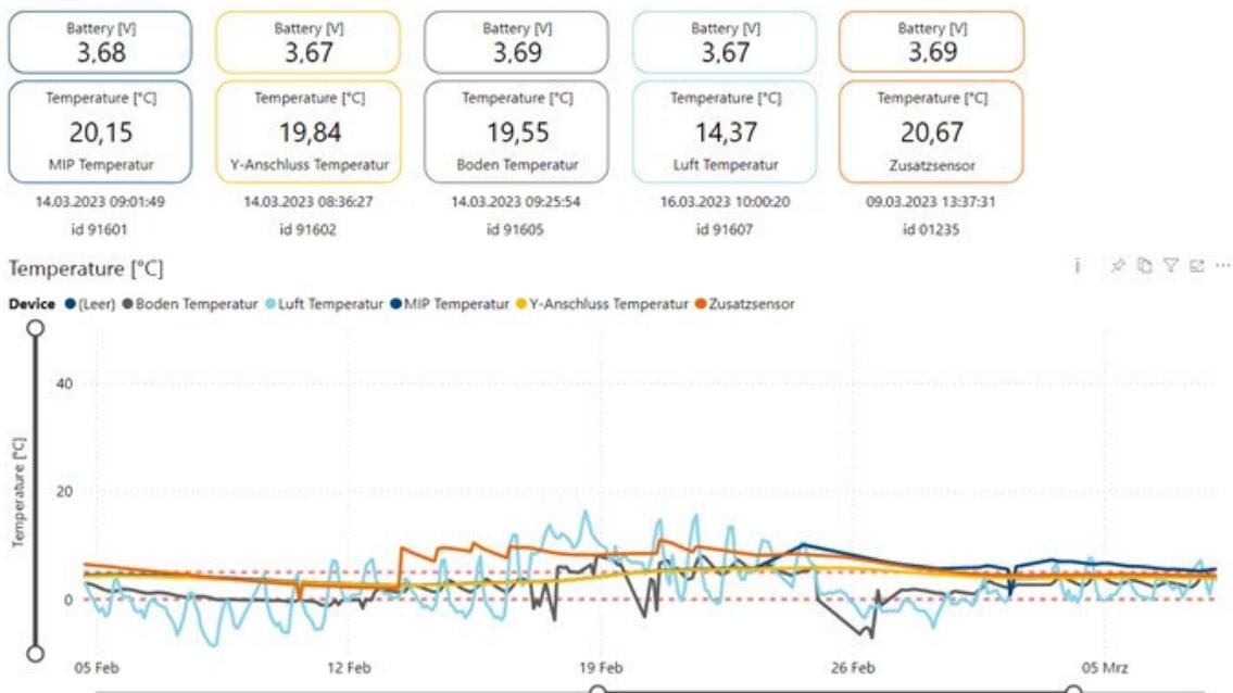
**Abbildung 9: Darstellung der Messdaten, des Temperaturverlaufes und der Status Informationen des IoT Device**
