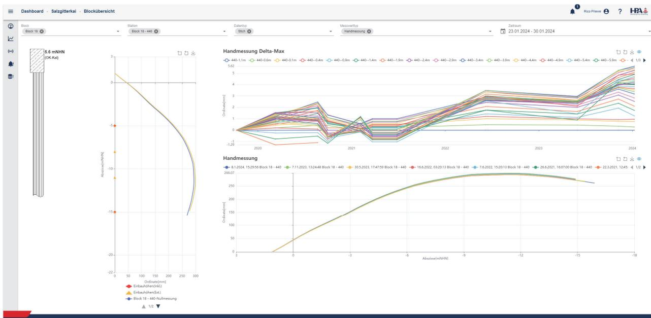
Manuelle tachymetrische Daten zeigen die Verschiebung des Kaikopfes in Millimetern an und können ebenfalls über den Zeitverlauf betrachtet werden.
