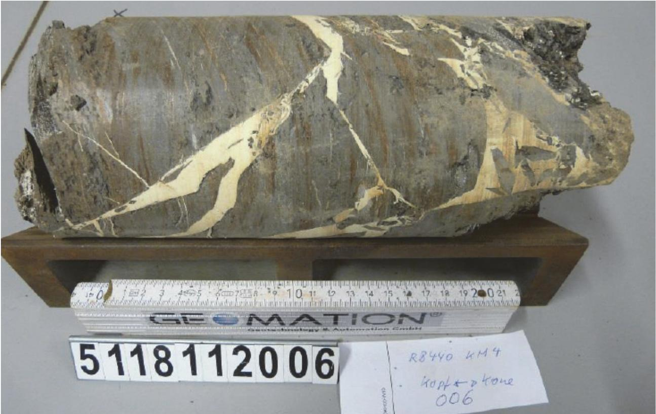
**Abbildung 9: Bohrkern bestehend aus Gebirge und 2-Komponenten Silikatharz zur Gebirgsverbesserung**
