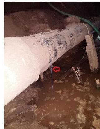
**Abbildung 7: Verteilte Dehnungsmessungen (Brillouin-Sensorik, links) an einer Hangrutschung im Pipeline-Monitoring bis zum Bruch des Sensorkabels (rechts)**
