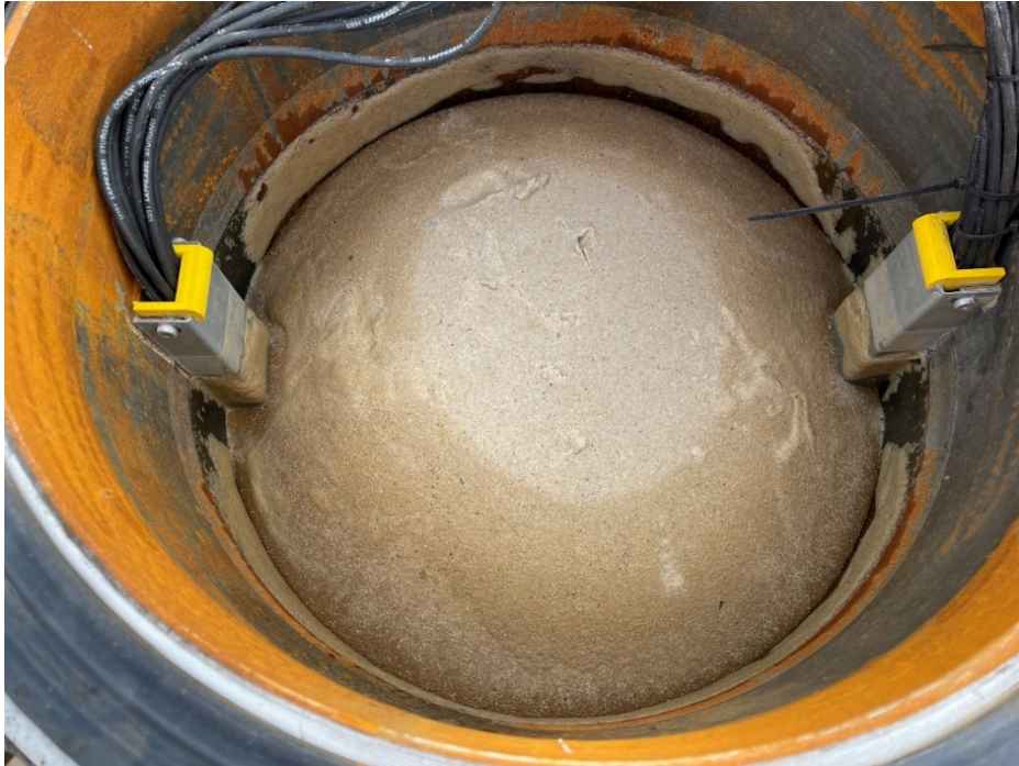
Abbildung 6-24: Hebung des Bodens im Pfahlinneren nach Pfahlinstallation
