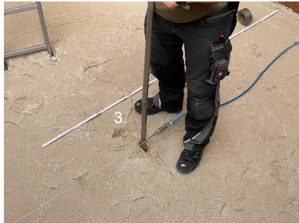
Abbildung 6-16: 1. Horizontale Totalspannungsgeber, 2. Porenwasserdruckgeber, 3. Einpressen der Totalspannungsgeber
