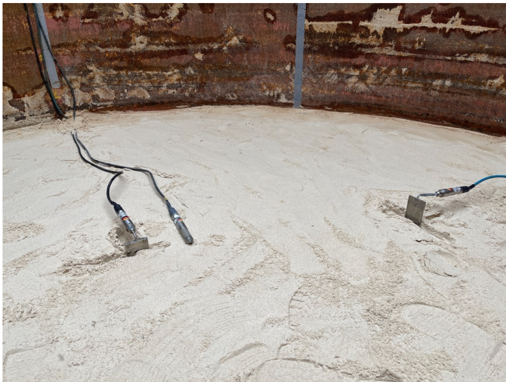
Abbildung 6-17: EDh- und Porenwasserdrucksensoren beim Bodeneinbau
