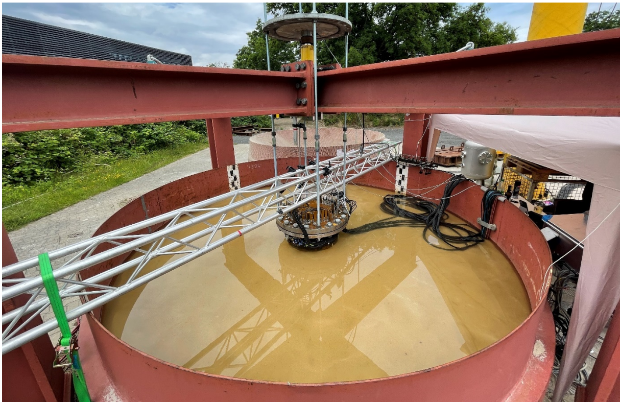
Abbildung 6-26: Versuchsaufbau statische Probelastung auf Zug
