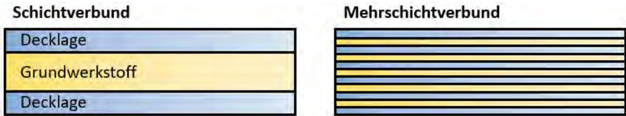
**Abbildung 1: das Prinzip von Schichtverbundwerkstoffen**
