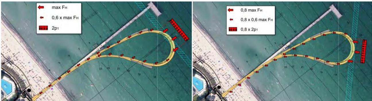
Abbildung 6: Laststellungen auf das Brückenbauwerk, Quelle: L+W
