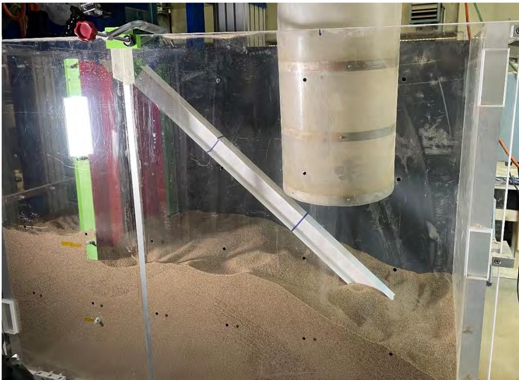
**Abbildung 3: Modellversuch einer einfach rückverankerten kombinierten Spundwand mit Kunststoffprofilen bei der Hinterfüllung der Wand mit dem Einrieseln von Sand**
