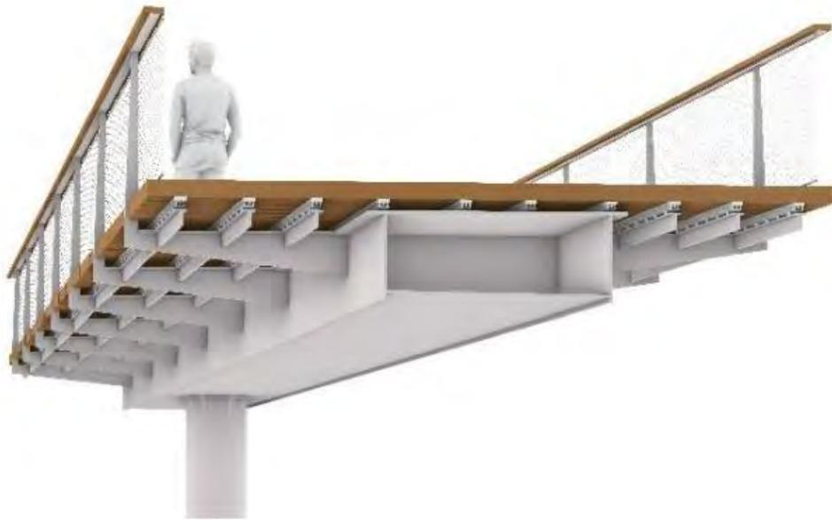
**Abbildung 11: Visualisierung Regelquerschnitt Brückendeck**
