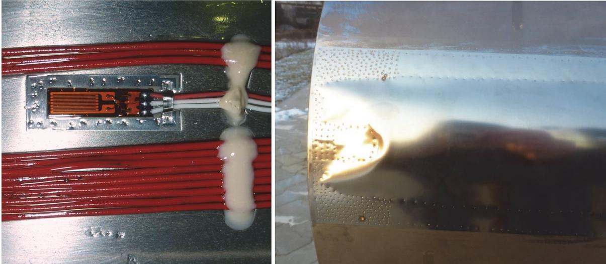
Abbildung 5-20: Aufgeschweißter DMS am Modellpfahl (links)
