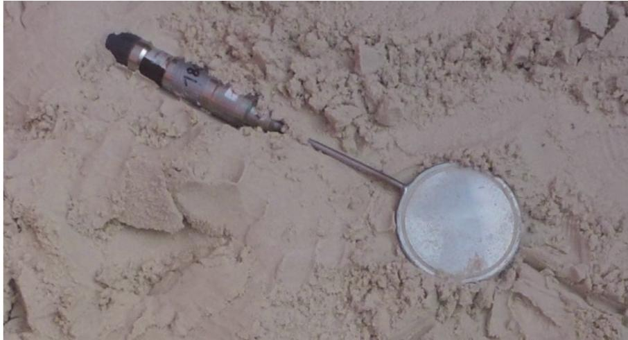
Abbildung 5-33: Erddruckgeber zur Messung der Vertikalspannung
