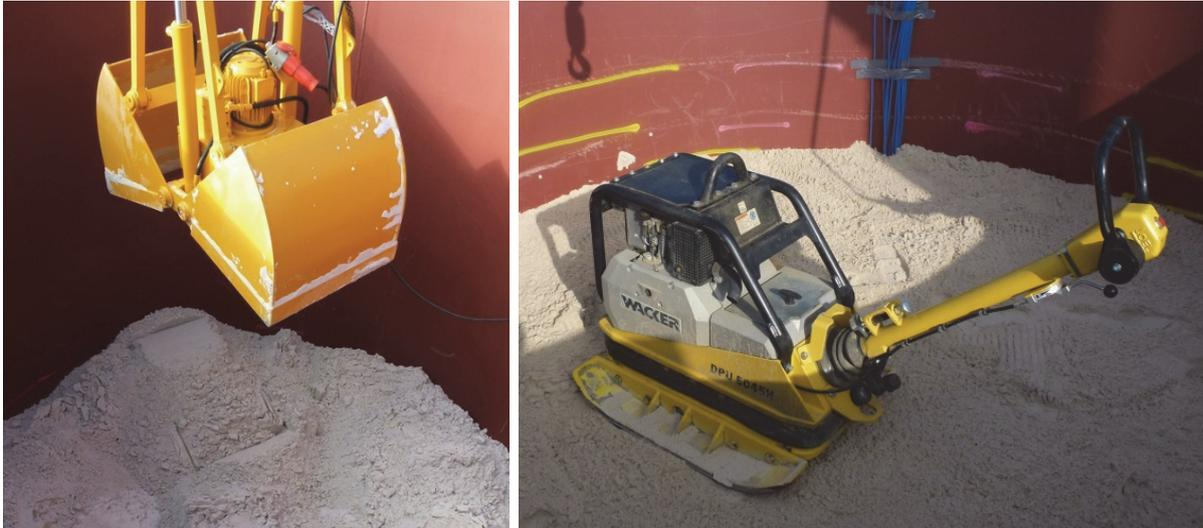
*Abbildung 5-5: Einbau des Modellsandes mit Zweischalengreifer (links)
