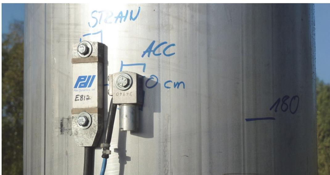
Abbildung 5-21: Dehnungs- und Beschleunigungsaufnehmer am Pfahlkopf
