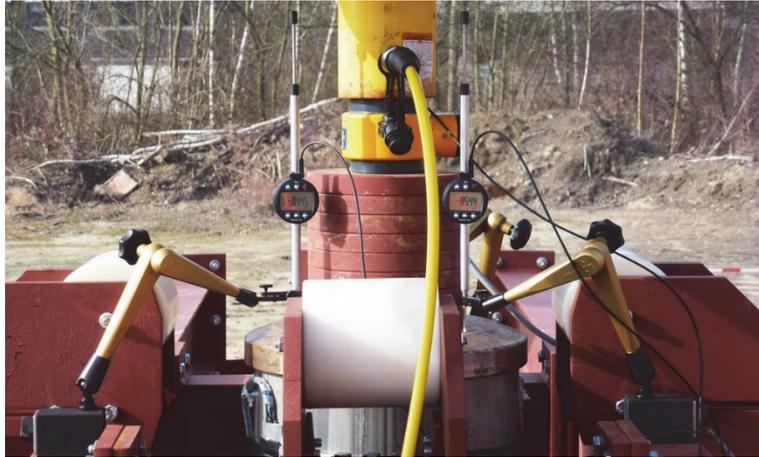
Abbildung 5-23: Messtechnische Anordnung bei einer statischen Probelastung
