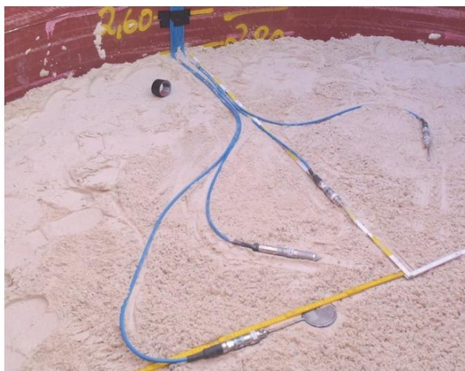
*Abbildung 5-11: Installierte Messgeber*
