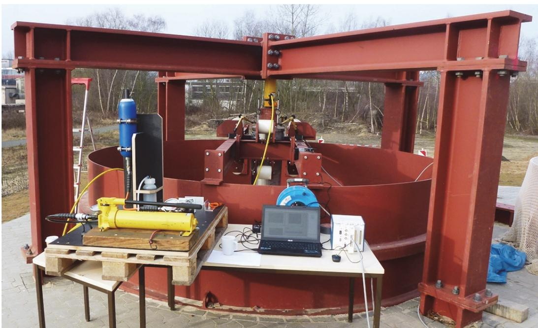
*Abbildung 5-22: Installierte Last-Rahmenkonstruktion zur Durchführung einer statischen Probelastung*
