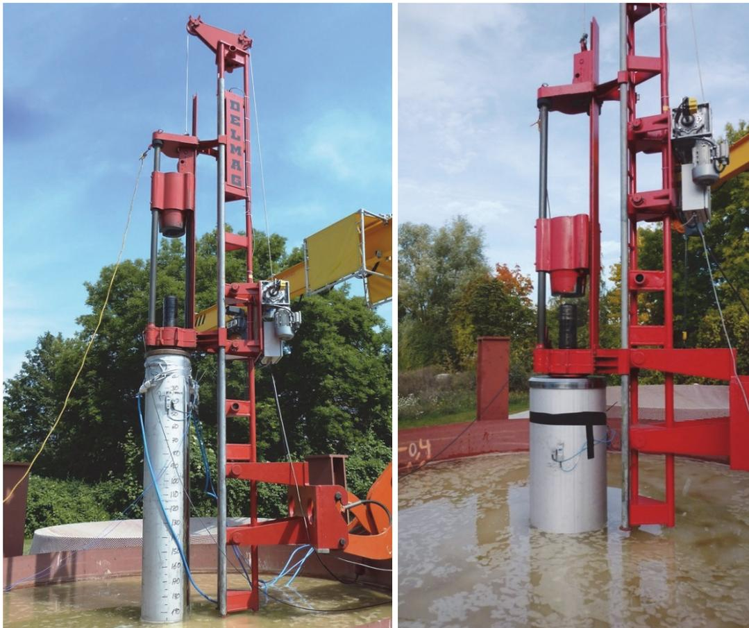
*Abbildung 5-18: Rammvorrichtung*
