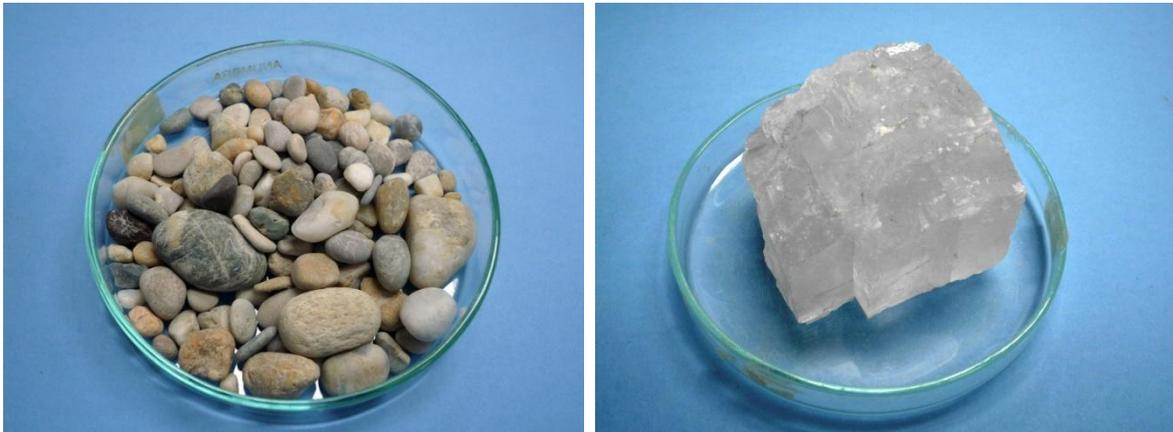
Abbildung 2-12: Vergleich einer Kiesprobe (links) und einer Steinsalzprobe (rechts)
