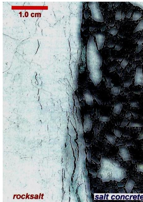
Abbildung 3-9: Dünnschliff des Übergangs ALZ im Steinsalz, in der Kontaktzone und im Damm aus [Müller-Hoepe et al., 2014]
