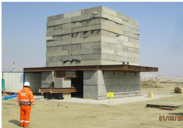
**Abbildung 11: Ansicht Totlastsystem**
