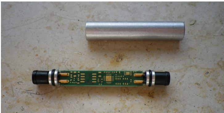
**Abbildung 1: Digitaler Temperatursensor mit Steckverbinder**
