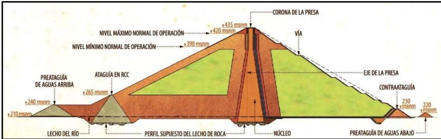
Abbildung 2: Querschnitt des Damms
