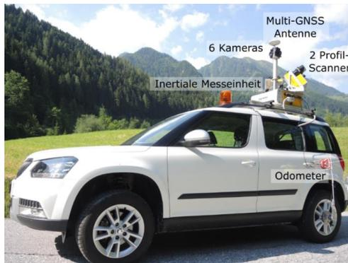
**Abbildung 9: Komponenten des Mobile Mapping Systems**
