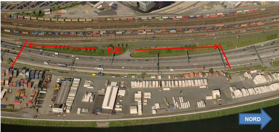
**Abbildung 1: Luftbild mit Bauwerksgrenzen der K30 (links: Übergang zur Hochstraße Elbmarsch im Süden, rechts: Übergang zum Trogbauwerk des Elbtunnels im Norden)**
