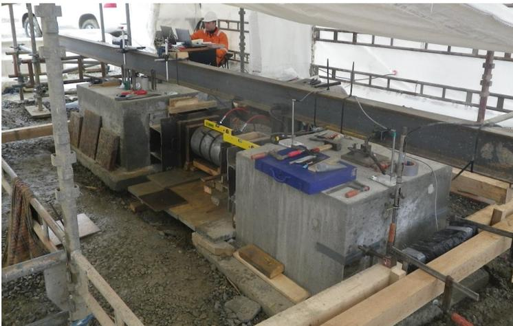
**Abbildung 9: Versuchsaufbau Horizontale Pfahlprobelastung SD2-1C**
