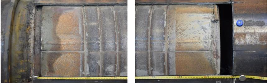
**Abbildung 11: Blick auf das Grout nach segmentweiser ( $135^{\circ}$ - $157,5^{\circ}$ ,  $157,5^{\circ}$ - $202,5^{\circ}$ )
