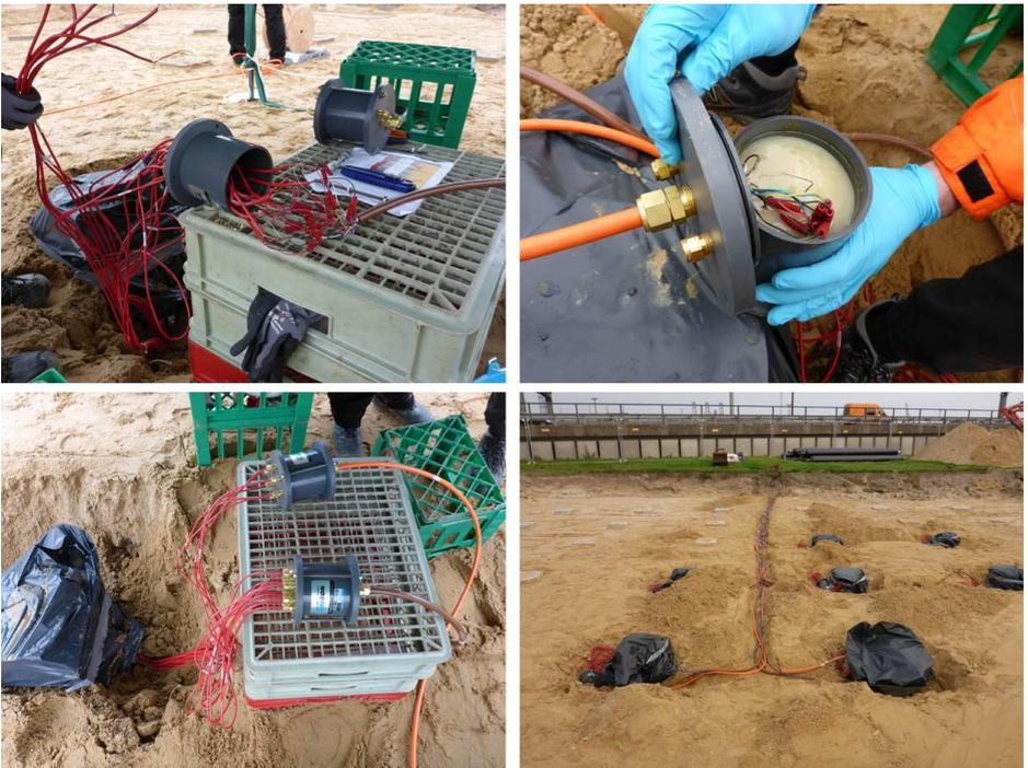
Abbildung 14: Kabelverbindung und -verlegung
