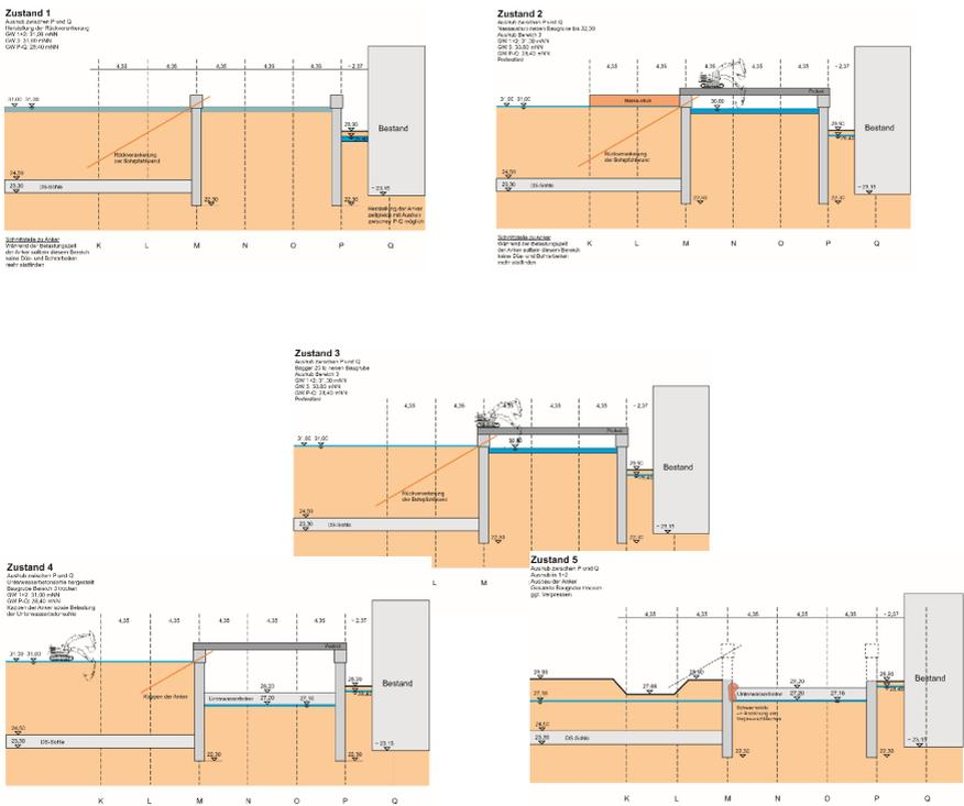
**Bild 18: Gewählte und ausgeführte Variante: Hochliegende UW-Beton-Sohle, umschließende Bohrpfahlwand, Unterwasserabbruch**
