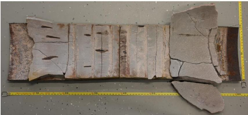
**Abbildung 14: Entnommenes Grout-Material aus der Belastungsachse (80 cm x 20 cm) von TP2 (oberer Teil des TP zeigt nach rechts)**
