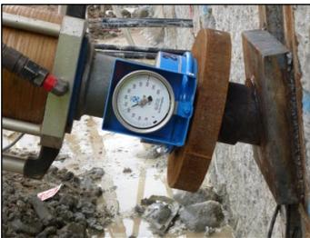
**Bild 1: Kraftmessdose am Ankerkopf**
