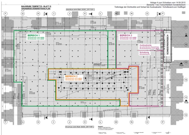
Bild 16: Bohr- und DS-Bereiche zur Herstellung der Dichtsohle im Tempetto
