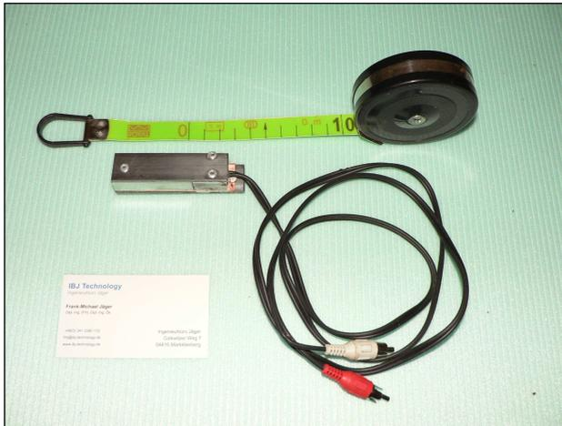
**Abbildung 1: Spannung- und Lastsensor BBS\_10\_DS**
