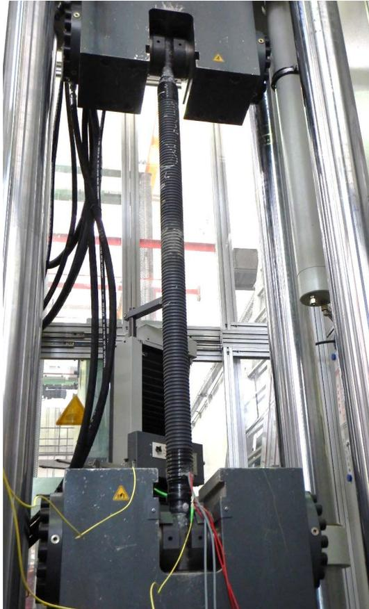
Abbildung 16: Vorbereiteter Zugversuch – verpresst
