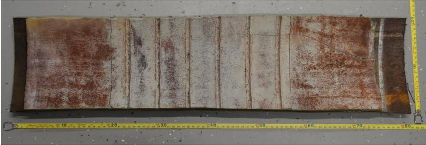
**Abbildung 13: Entnommenes Grout-Material aus der Belastungsachse (80 cm x 20 cm) von TP1 (oberer Teil des TP zeigt nach rechts)**
