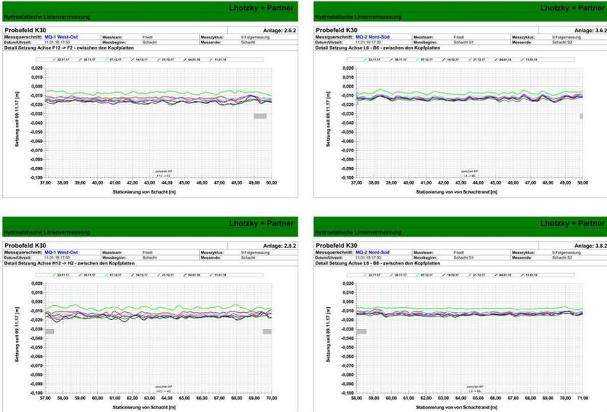
Abbildung 17: Setzungen zwischen den Kopfplatten
