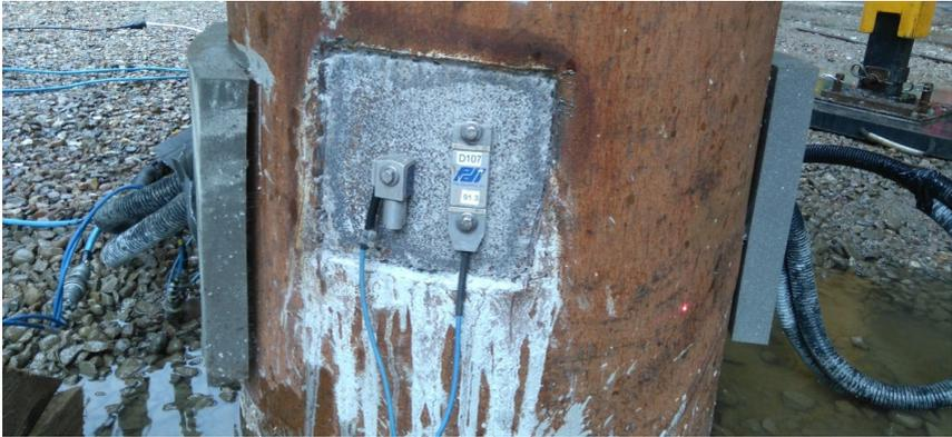
**Abbildung 4: Kopfinstrumentierung mittels konventioneller Dehnungs- und Beschleunigungsaufnehmer**
