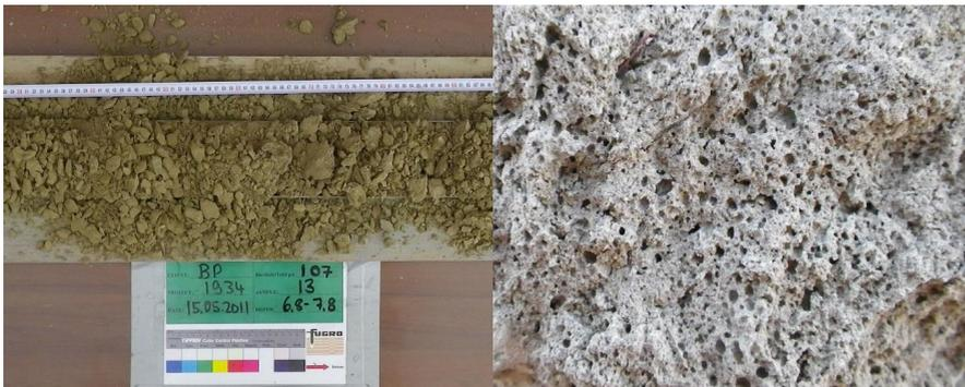
**Abbildung 1: Unit 1 Liner-Probe (links) und poröse Struktur (rechts)**
