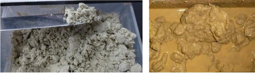
**Bild 4: Bodenproben aus Abschnitt 3 der Raibler-Formation (links: trocken, rechts: wassergesättigt)**
