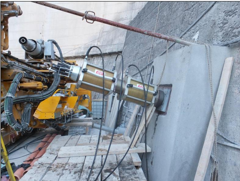
**Bild 18: Eignungsprüfung und Festlegen der Litzenanker**
