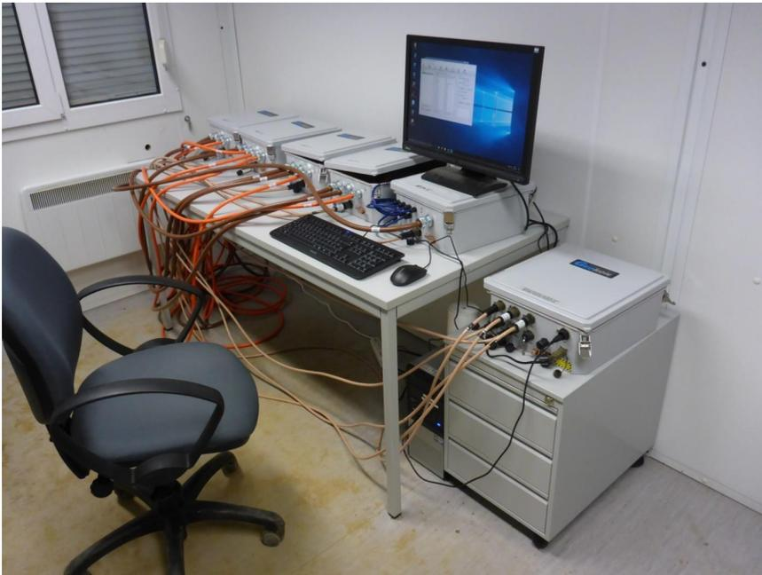
**Abbildung 15: Multiplexer und Datalogger**
