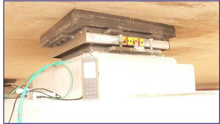
Abbildung 29: Messung mit BG80DL
