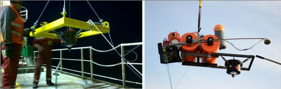
**Abbildung 4: SLS-System am Kran (links) und gekoppeltes SLS-System mit Lobster (rechts)**
