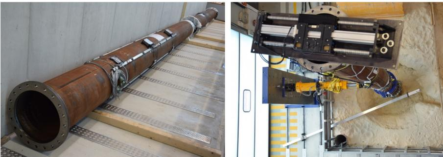
**Abbildung 3: Pfahl mit Turm und Sensorik vor der Installation (links) und Pfahl mit Shaker und Hydraulikzylinder während des experimentellen Versuchs (rechts)**
