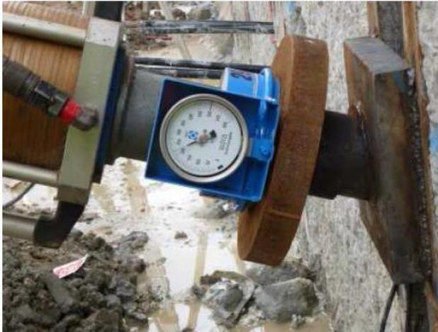
**Abbildung 2: Kraftmessdose mit Bourdon-Manometer**
