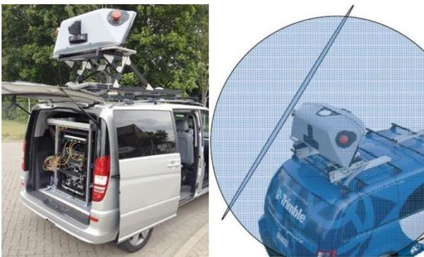
Abbildung 5: Fahrzeug mit Trimble MX-8 System (links) und 360° Scanradius (rechts) [GIL GmbH, 2015]
