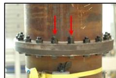
**Abbildung 7: Auswirkung von gelockerten Schrauben am Flansch**
