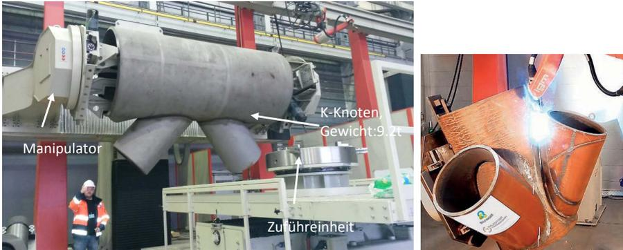
Abbildung 8: a) Implementierte Roboterschweißstation bei Bilfinger Mars Offshore (li.)
