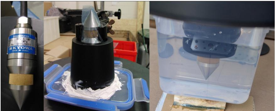
**Abbildung 2: Einbau des Porenwasserdruckgebers**
