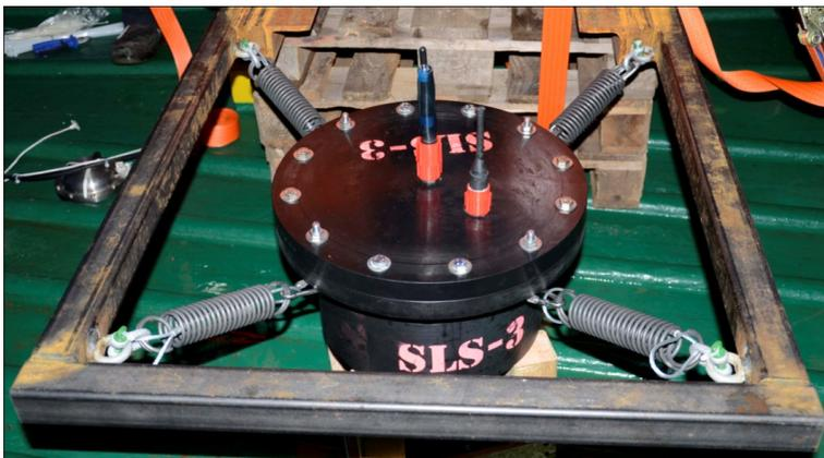
**Abbildung 3: Montiertes SLS-System mit gefederter Aufhängung im Stahlrahmen**
