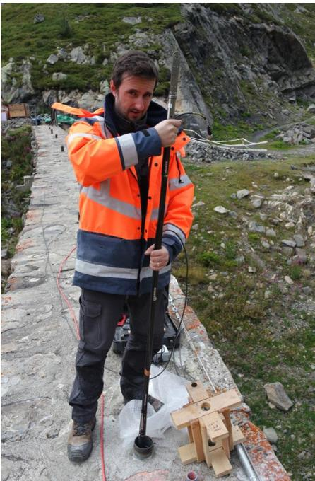
Abbildung 5: Einbau Ketten-Inklinometer Bohrung A1
