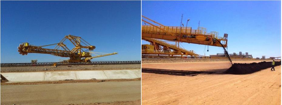
**Abbildung 5: Bagger zur Entnahme und Einlagerung von Eisenerz**
