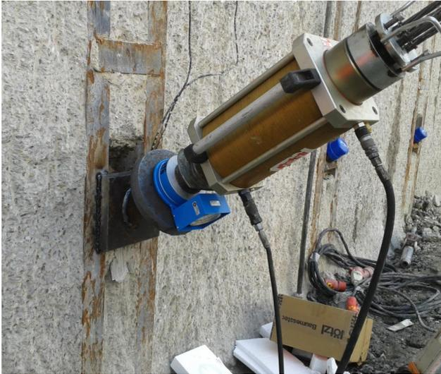
Abbildung 8: Installierte Kraftmessdose und DYNA Force® Sensoren am Messanker
