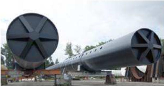
Abb. 1: Hubbeine eines Errichterschiffes ohne Spudcan
