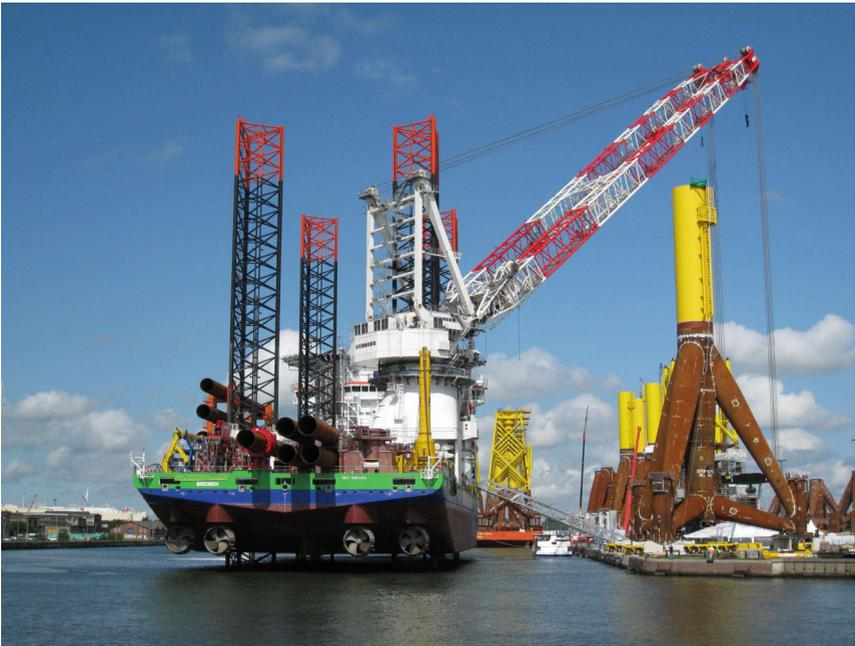
Abbildung 5: Aufgepratztes Errichterschiff vor einer Kaje
