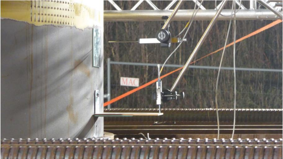
Abbildung 13: Wegaufnehmer außerhalb (oben) oder am Rande seines Messbereiches
