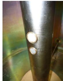
Abbildung 2: Frontmembransensor zur Messung der totalen Spannungen und des Porenwasserdruckes an der Vorder- und Rückseite des Pfahlsegmentes
