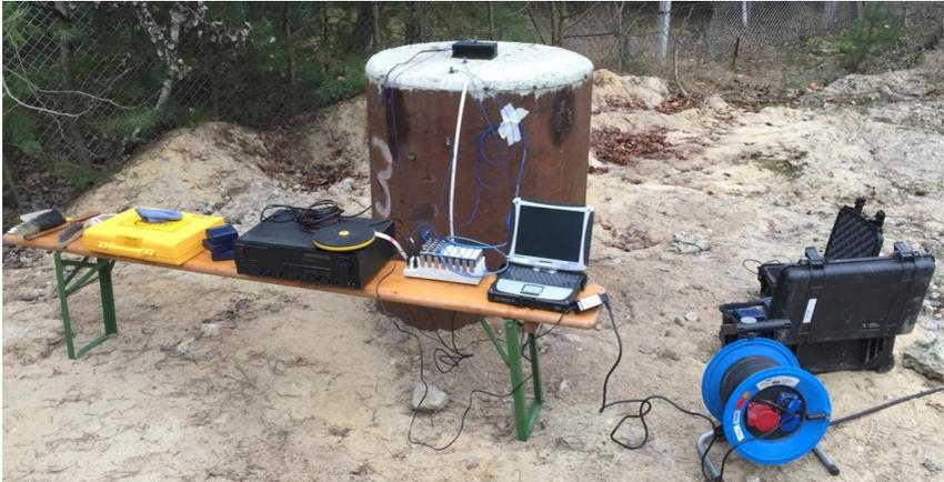
Abbildung 3: Experimenteller Aufbau und Testmessung an einem unbeschädigten Referenzpfahl (11 m lang) auf dem BAM TTS-Testgelände in Horstwalde, Brandenburg
