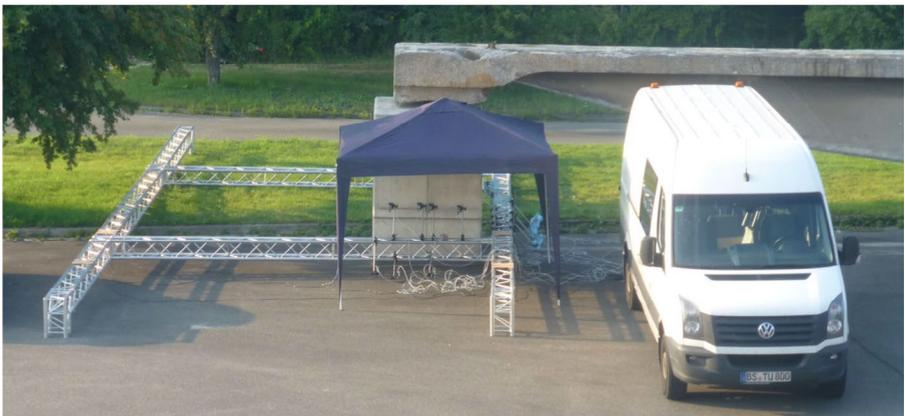
Abbildung 10: Ermittlung der Temperatureinflüsse auf die IGB-TUBS-Messbrücke
