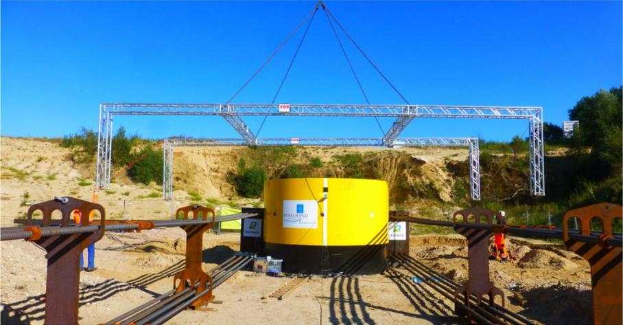
Abbildung 9: Einfaches Versetzen der kompletten IGB-TUBS-Messbrücke
