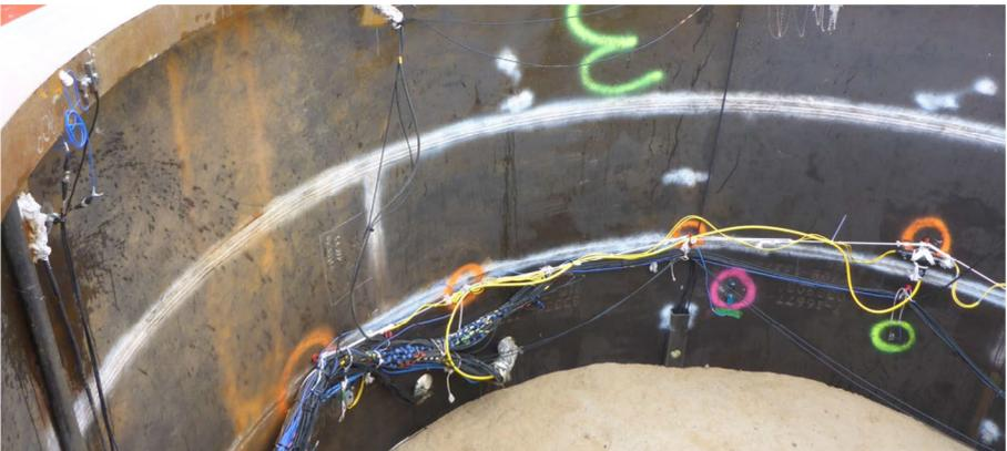
Abbildung 20: Intakte Sensorik und Kabelhalterungen nach der Rammung
