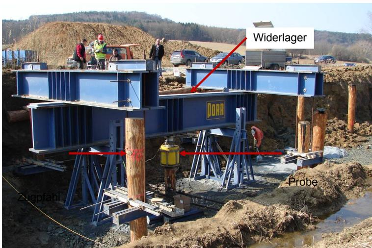
Abbildung 2: Übersicht zur Widerlagerkonstruktion der statischen Pfahlprobelastungen
