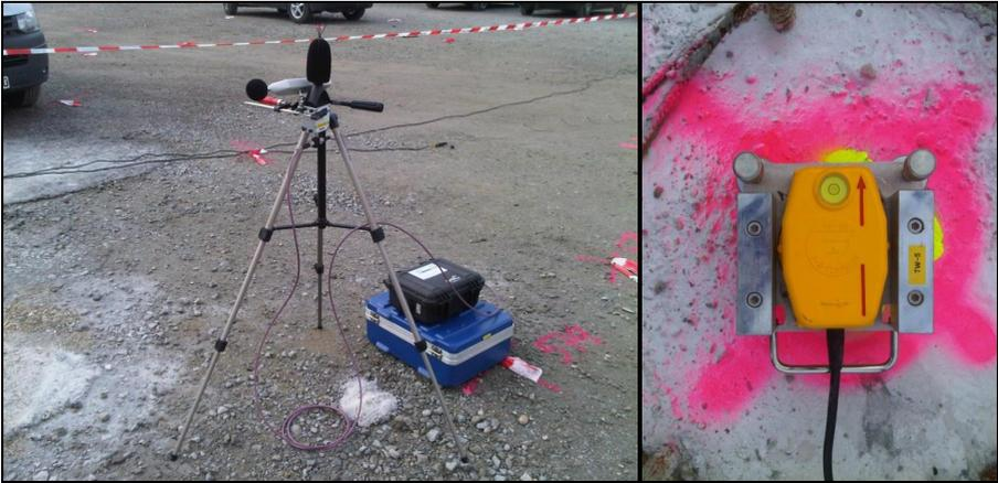
Abbildung 14: Schallpegel- und Erschütterungsmessung, Deggendorf
