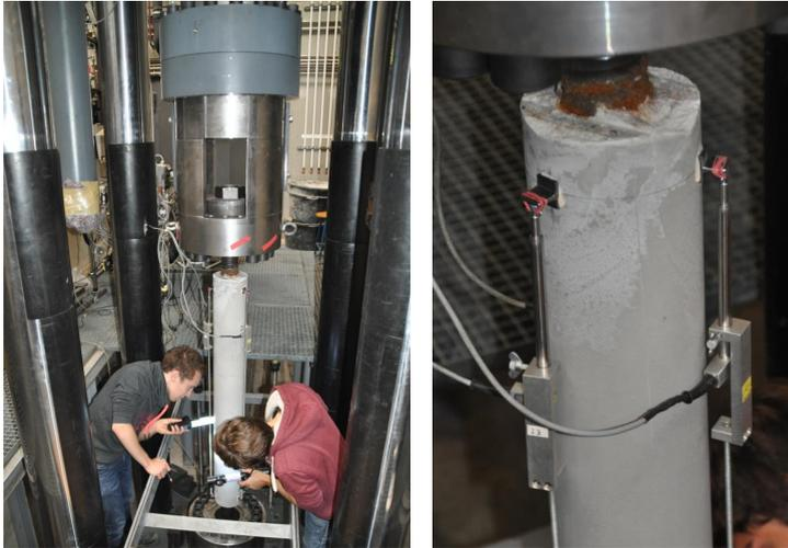
Abbildung 14: Dehnkörperversuche mit Messsensoren in einer 5 MN Zugmaschine und visuelle Rissbreitenbestimmung mit Risslupe
