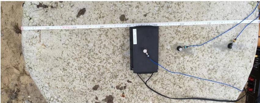
Abbildung 4: Anordnung des Vibrators und der Sensoren auf der Pfahlkopfoberfläche
