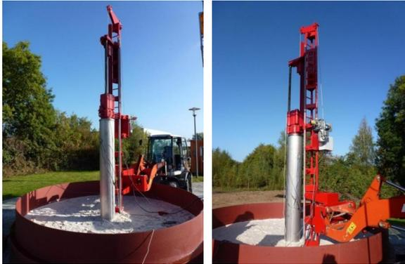
Abbildung 11: Radlader, Mäkler, Hammer
