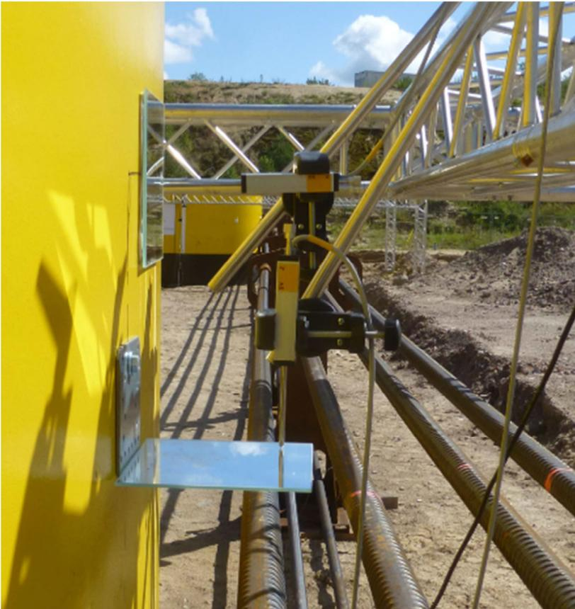
Abbildung 6: Spiegel-Tastflächen und Ausrichtung der Wegaufnehmer
