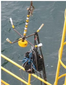
Abbildung 13: Bergung Messkabel für Restrike Tests
