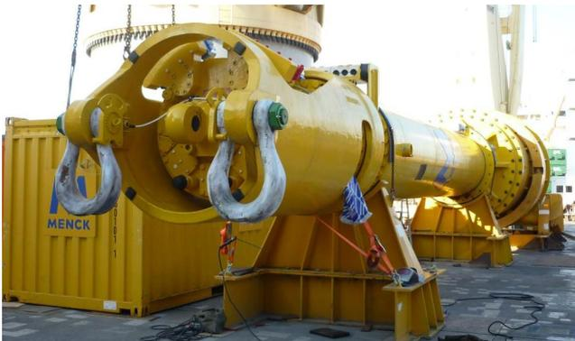
Abbildung 5: Hydraulischer Hammer MHU 800S
