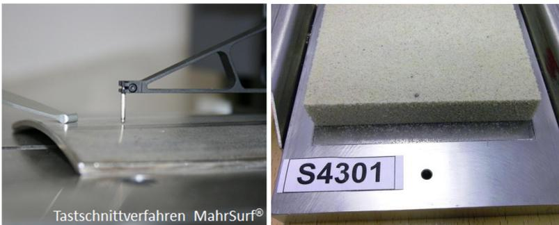
Abbildung 13: Messverfahren zur Bestimmung der Oberflächenrauigkeit (links), direkter Scherverversuch zur Bestimmung des Kontaktreibungswinkels (rechts)
