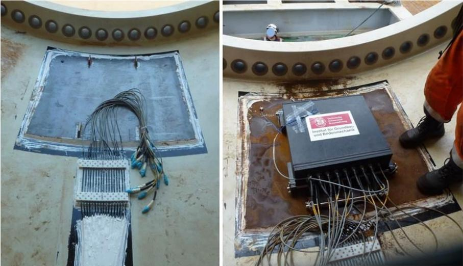
Abbildung 6: Trägerplatte, Zugentlastung und angeschlossene Messbox
