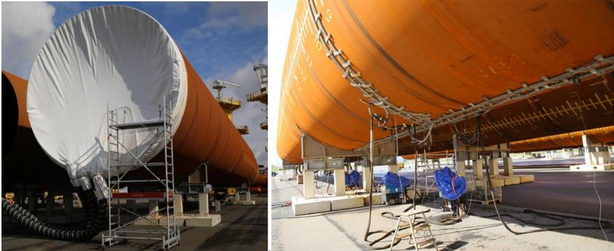
Abbildung 3: verschlossener und beheizter Pfahl (links), Induktionsheizung (rechts)
