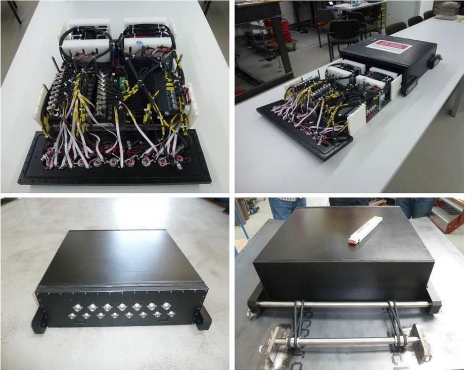
Abbildung 5: Messwerterfassung und Spannungsversorgung (oben), druckwasserdichte und bruchsichere Messbox (unten links), Aufhängung an Trägerplatte (unten rechts)
