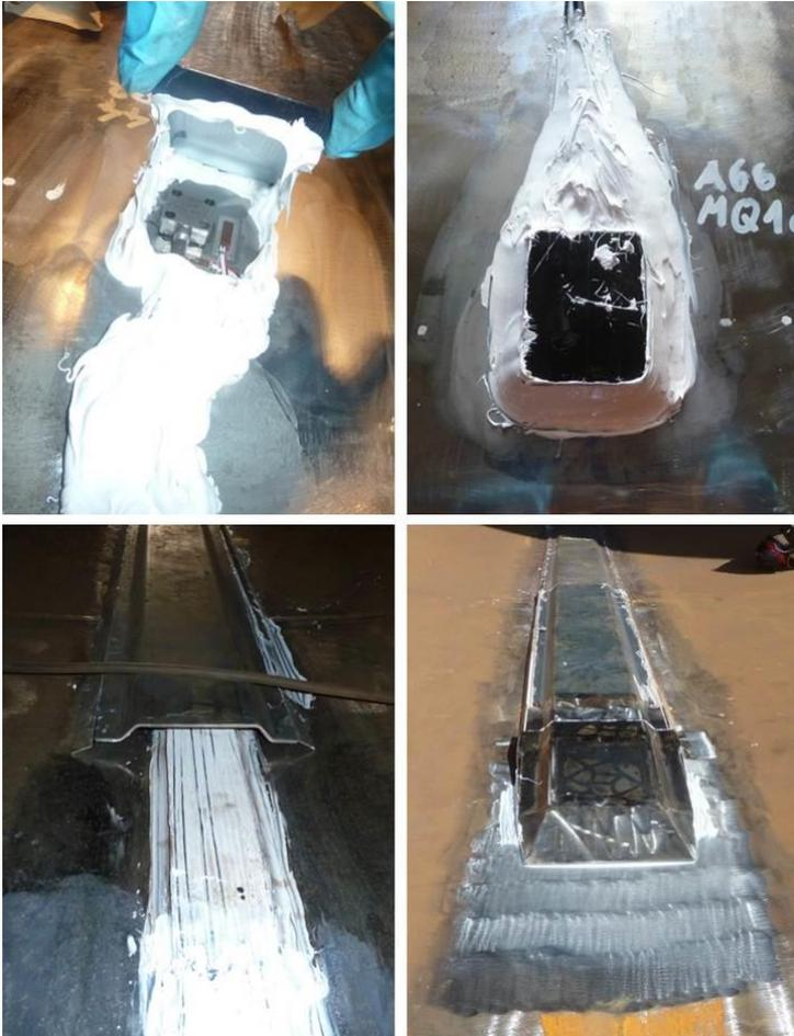
Abbildung 4: gedeckelte Sensoren (oben links), Deckel in Dickschichtklebung (oben rechts), Trapezprofil (unten links), Rammschuh (unten rechts)
