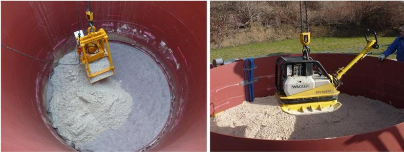
Abbildung 7: Einbau des Modellsandes mit Zweischalengreifer und Rüttelplatte
