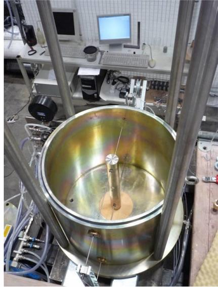
Abbildung 1: Gesamtansicht der Versuchsanlage (links); unterer Ring  $\varnothing_{\text{innen}}$  600 mm des Behälters mit eingestelltem Modellpfahlsegment  $\varnothing$  60 mm (rechts)
