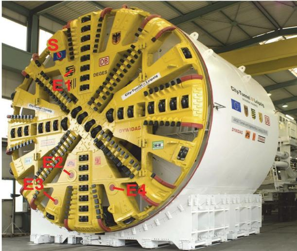
**Abbildung 1** : Ansicht des Schneidrades S-326 (Leipzig). Die SSP-Komponenten sind mit S (Sender) und E1, E2, E3, E4 (Empfänger) gekennzeichnet
