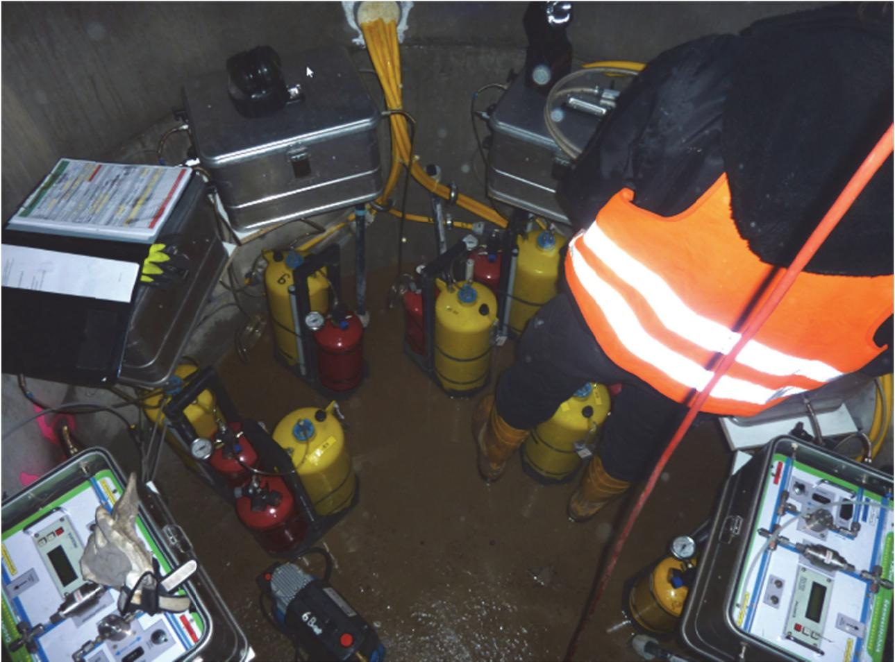
Abb. 5.4: instrumentierter Messschacht für die hydrostatische Linienvermessung
