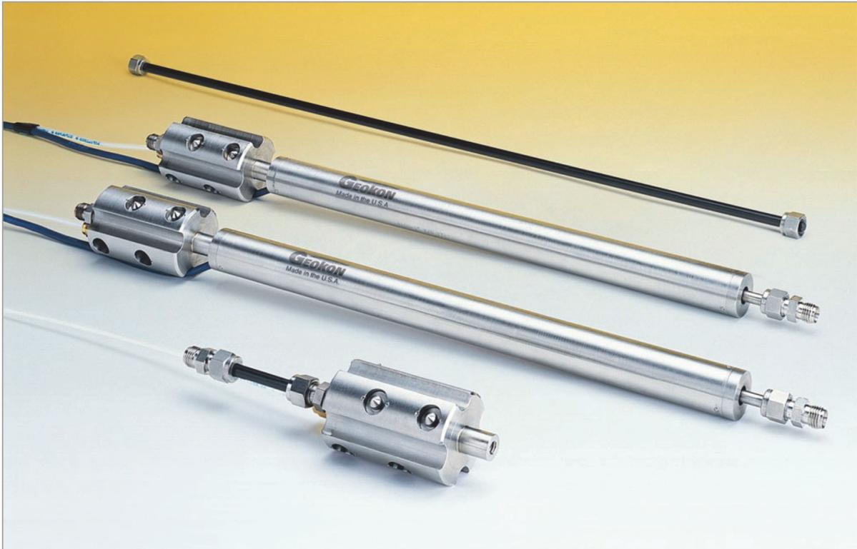
Bild 7: Komponenten des wiedergewinnbaren Kettenextensometers
