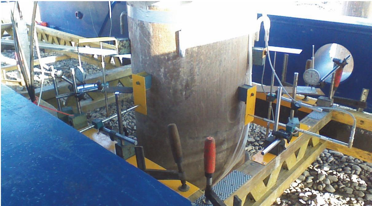
Bild 11: Anordnung der Wegaufnehmer am Pfahlkopf
