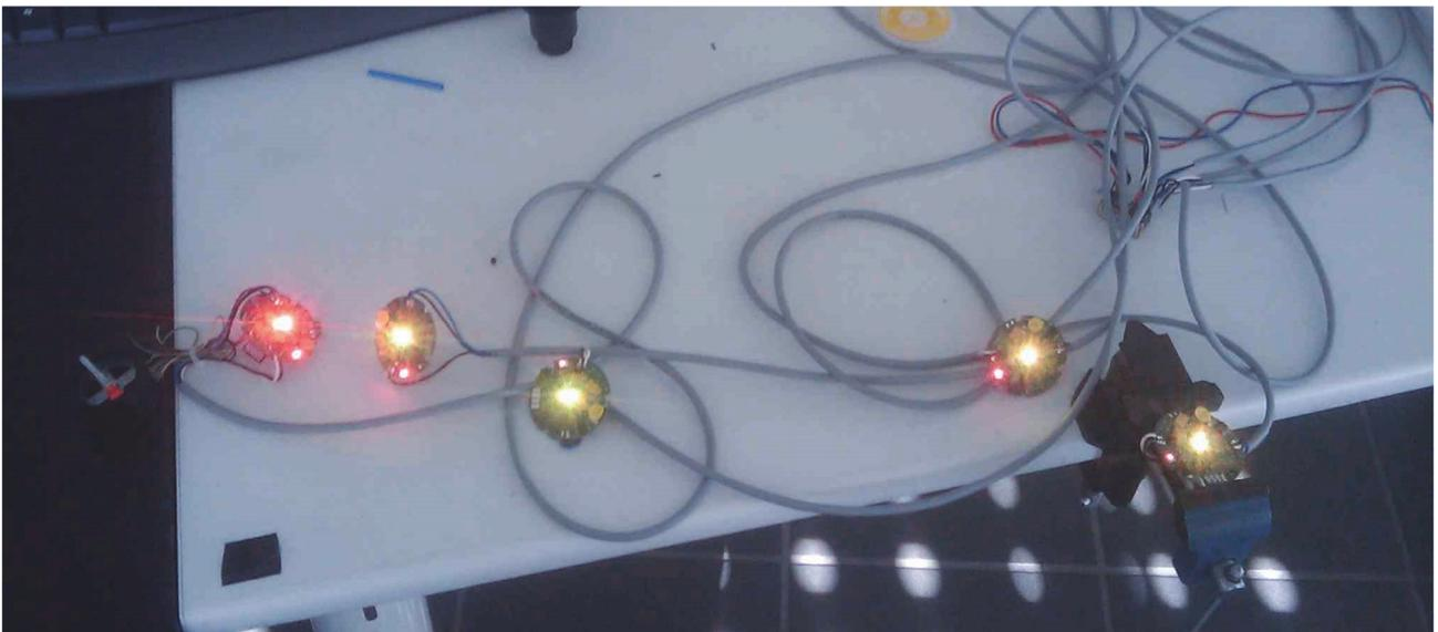
**Abb. 11: Mehrere Platinen zum Test in Reihe geschaltet)**
