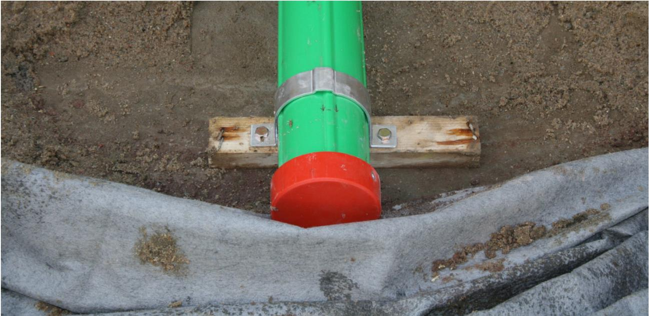
Abb. 15: Zugängliches Ende des Inclinometerkanals
