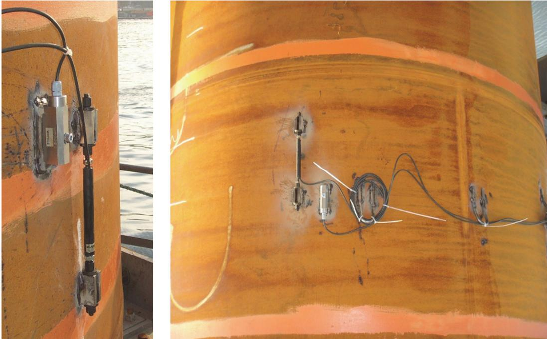
**Abbildung 2:** Sensoren für große Wassertiefen appliziert an einem Großrohrpfahl offshore (System TNO, Niederlande)
