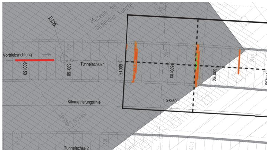
**Abbildung 3:** Detektierter Geologiewechsel, in diesem Fall eine Sandstein-/Quarzitbank
