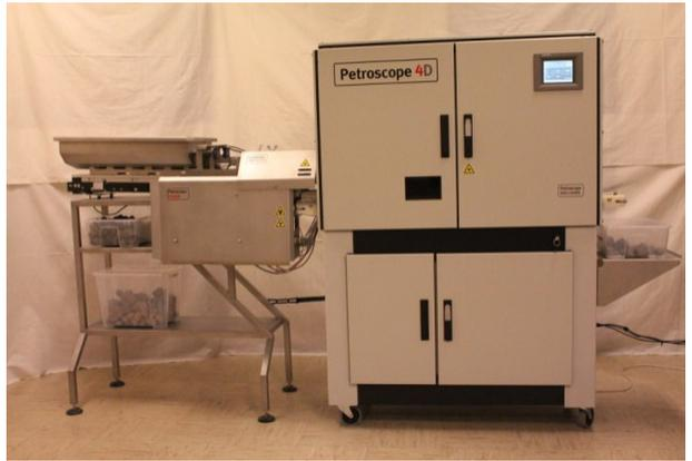
Petroscope misst und berechnet für jedes Einzelkorn: •Siebweite •Volumen •Kornoberfläche •Rundungsgrad •Hauptachsen •Plattigkeit •Stengeligkeit •Formklasse •Gesteinsart
