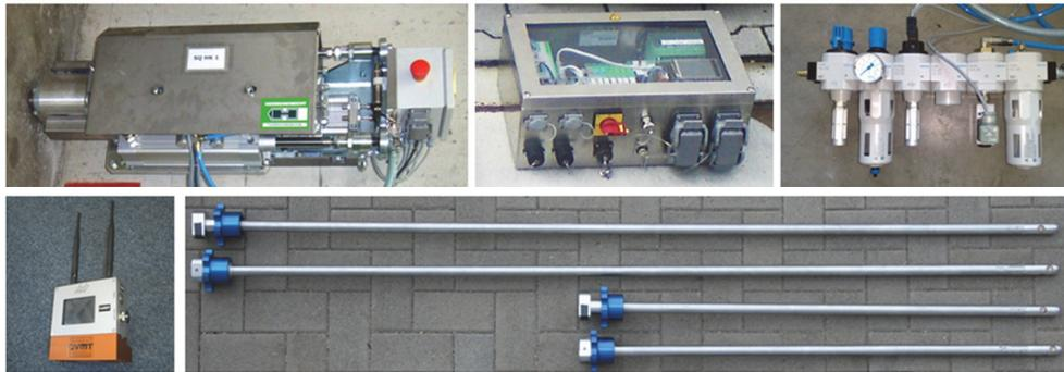
**Abbildung 4.** ISIS Hardware. Schlagimpulsgenerator, Steuereinheit, Wartungseinheit, Funkdatenlogger und 3-Komponenten-Geofonmessanker
