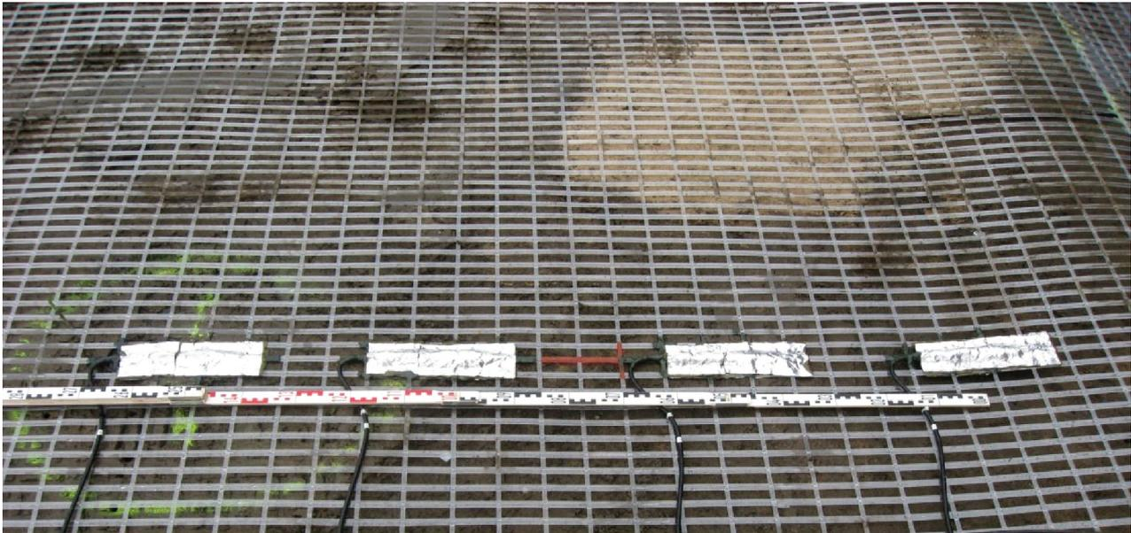
Abb. 9: Lage der vier Dehnungsmessstreifen
