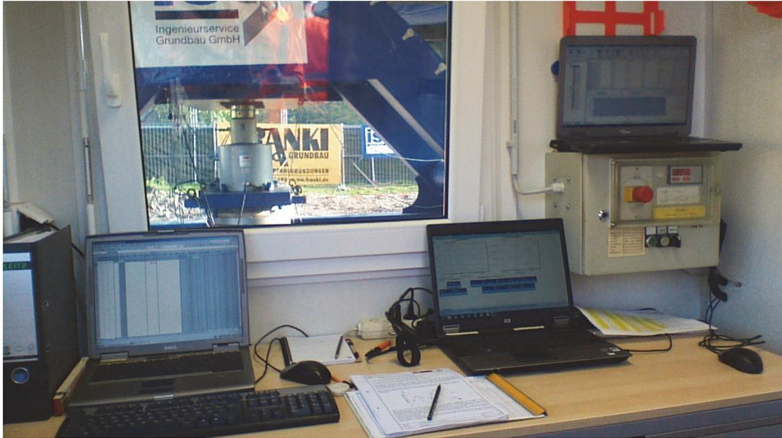
Bild 12: Messstand (v.l.): PC für Protokollierung, PC für Messwertanzeige am Pfahlkopf, Pumpensteuerung mit Lastkonstanthaltung (unten), Datenlogger zur Erfassung aller Messwerte (oben)
