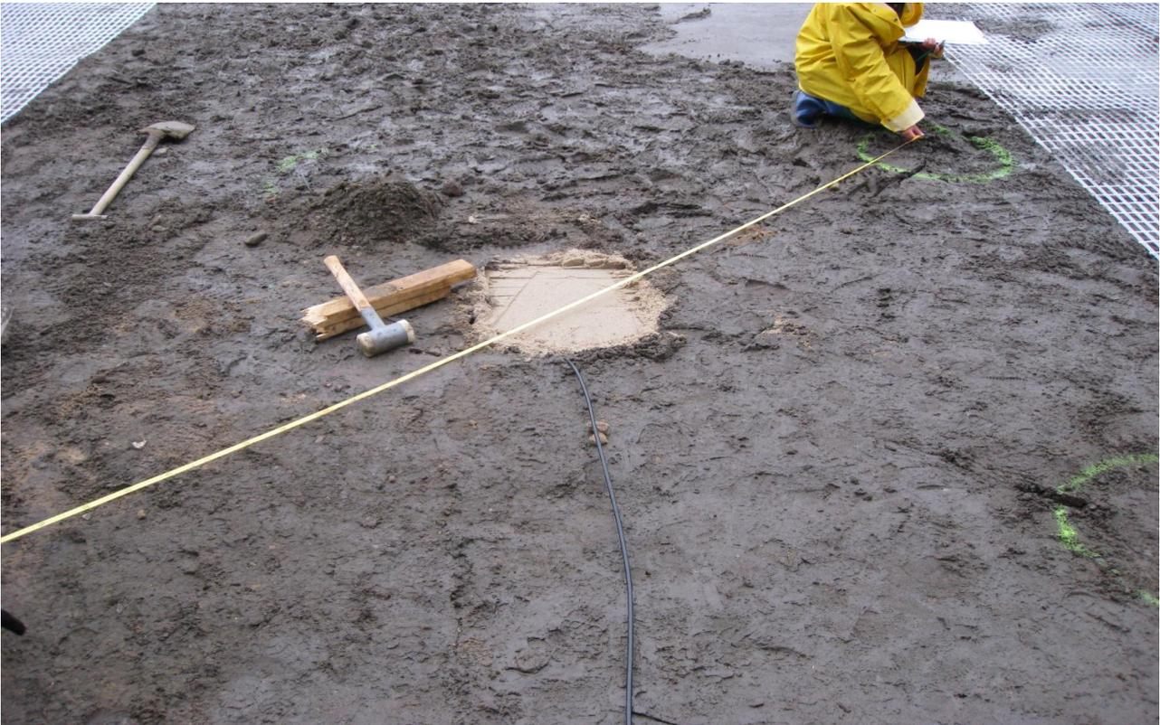
Abb. 13: Einbau des unteren Erddruckgebers in Feldmitte
