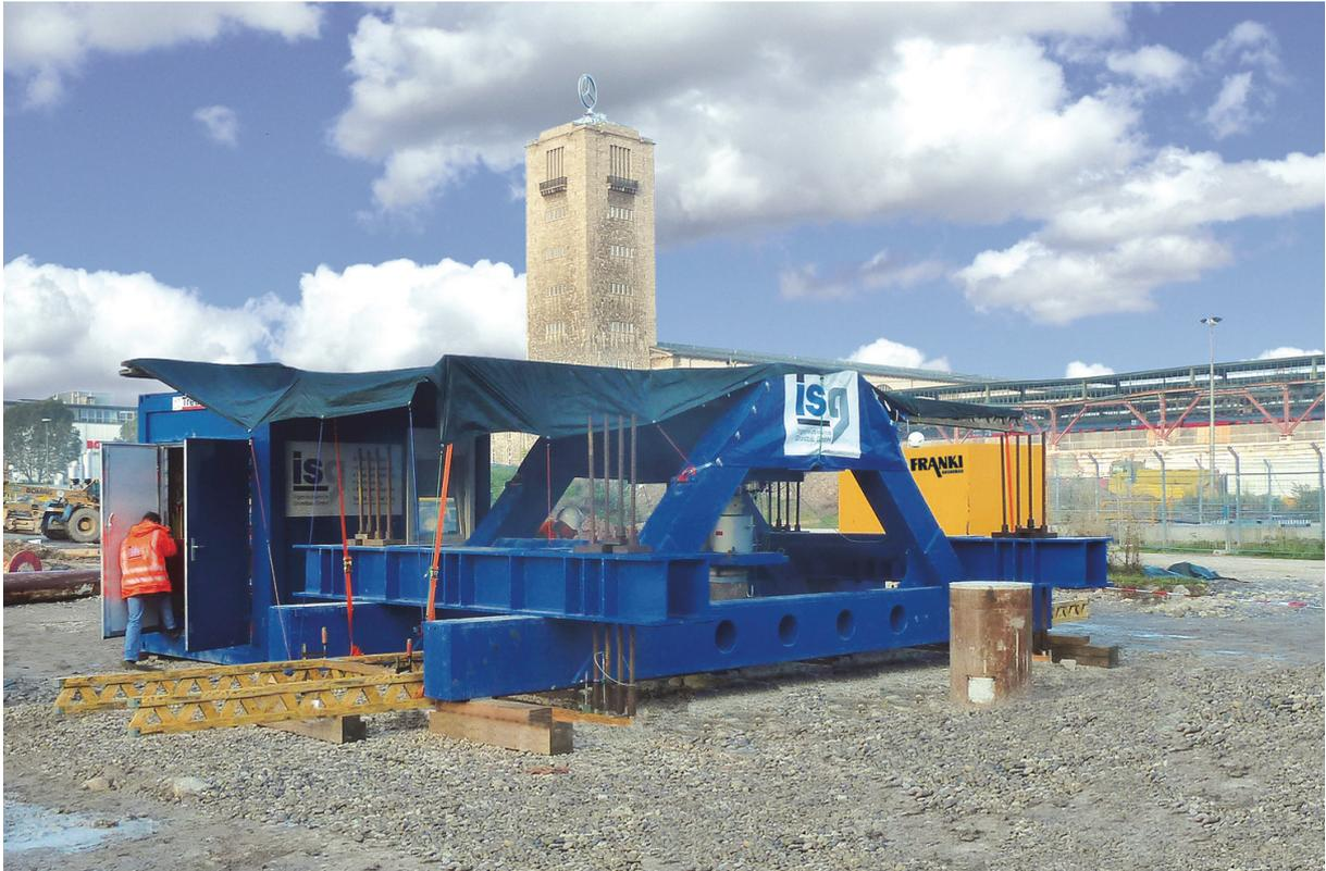
Bild 10: Probelastungsaufbau
