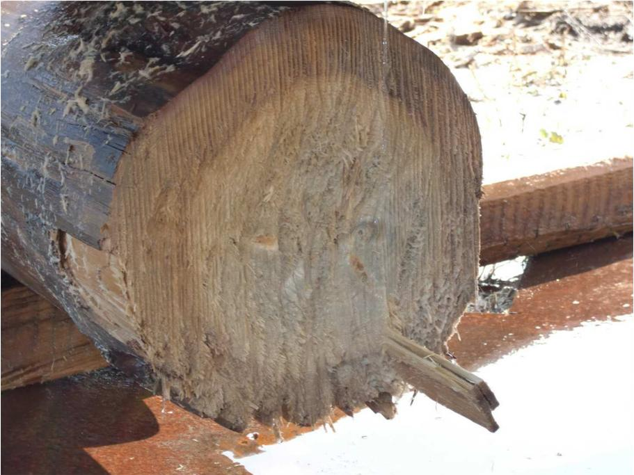
Abbildung 3: Gründungspfahl von 1897 nach dem Schnitt
