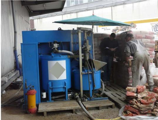
Abbildung 7: Verpressstation
