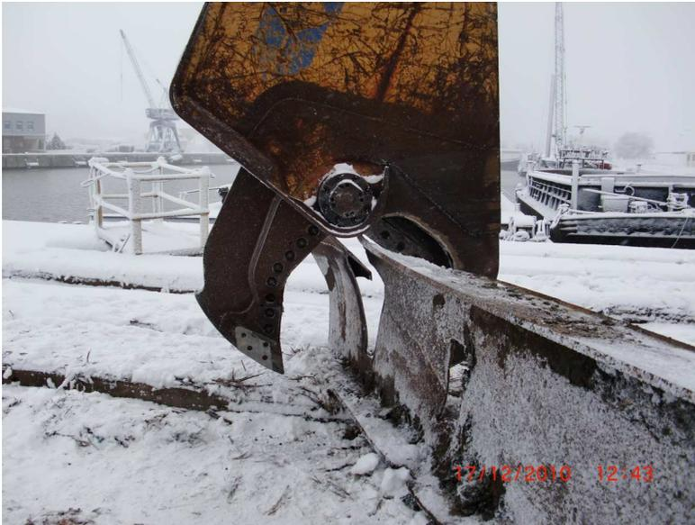
Abbildung 15: Probeschnitt am PSt 1000
