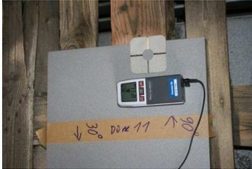
**Abbildung 1:** Dokumentation der Rauheitsmessung.
