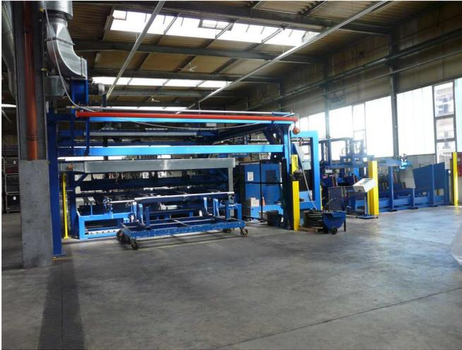
Abbildung 5: Vollmechanische Anlage zur Herstellung von Stahl-Traggliedern für Verpresspfähle TITAN
