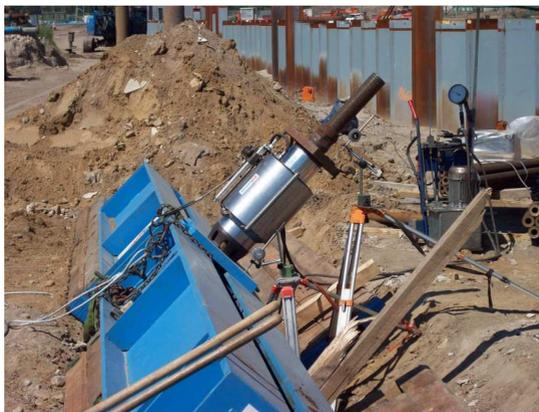
Abbildung 9: Probelastung am Probepfahl
