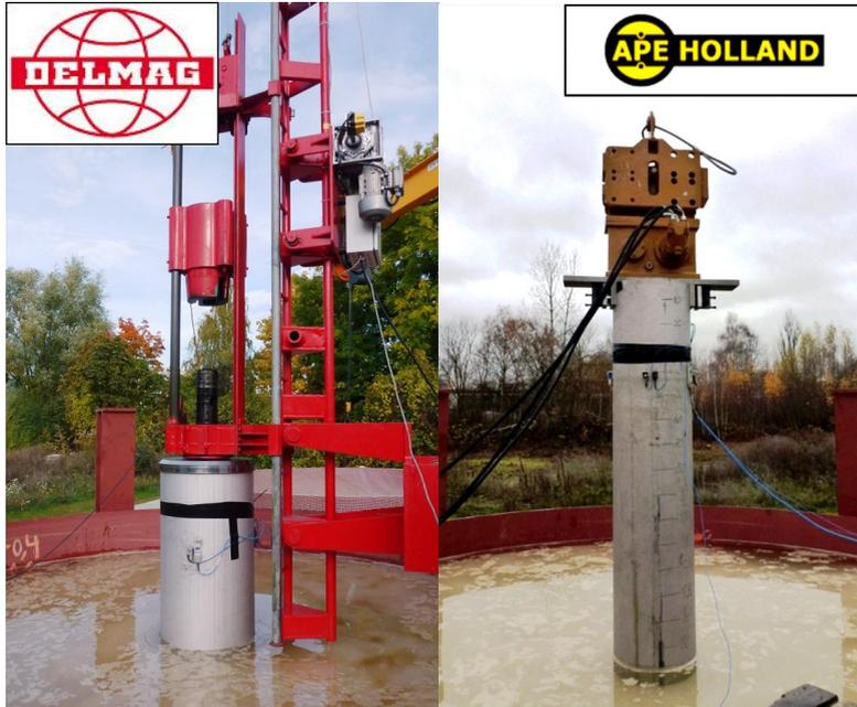
Abbildung 6: Schlag- und Vibrationshammer am IGB-TUBS
