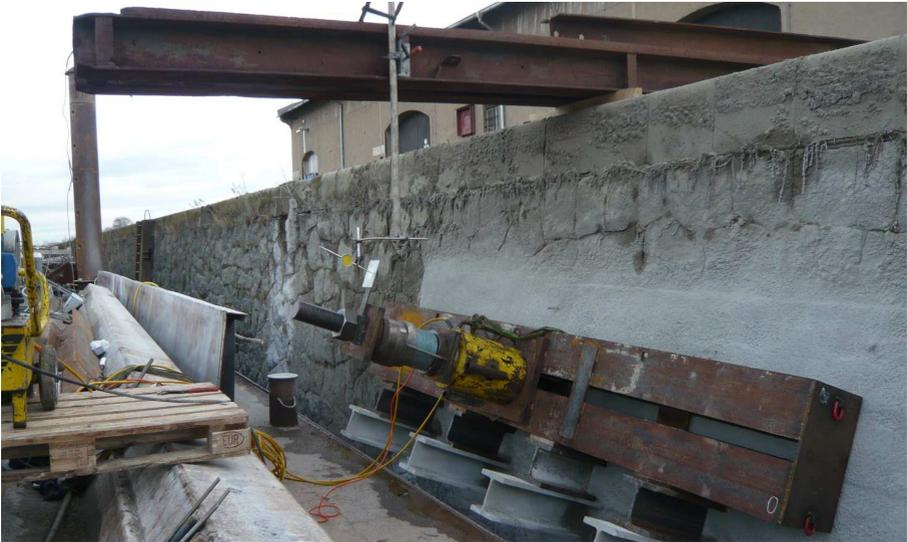
Abbildung 22 Probekörperbelastungseinrichtung
