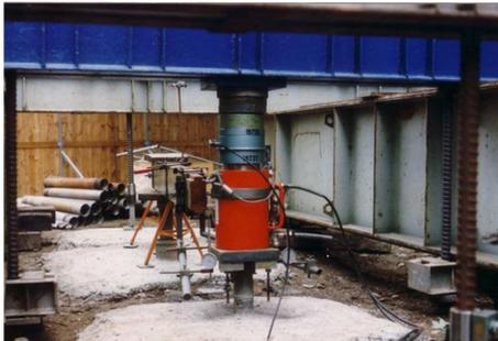
Abbildung 10: Druckprüfung am Bauwerkspfahl
