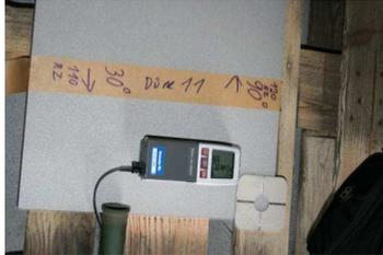
**Abbildung 2:** Dokumentation der Rauheitsmessung.
