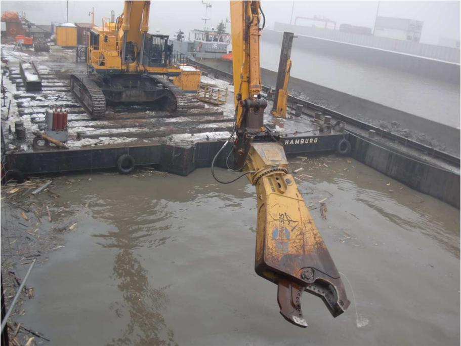
Abbildung 13: Schrottschere beim Einsatz am 170-t-Hydraulikbagger
