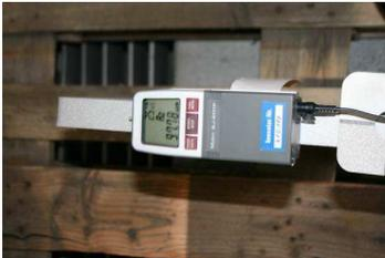
**Abbildung 3:** Dokumentation der Rauheitsmessung.
