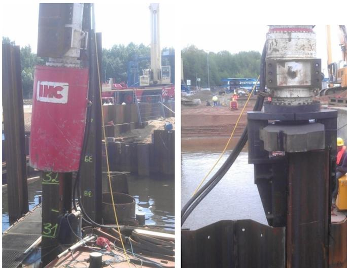
Abbildung 4: Probelastung an einer Tragbohle mit schräg aufgesetztem Hammer (links), exzentrische Belastung einer Tragbohle (rechts)
