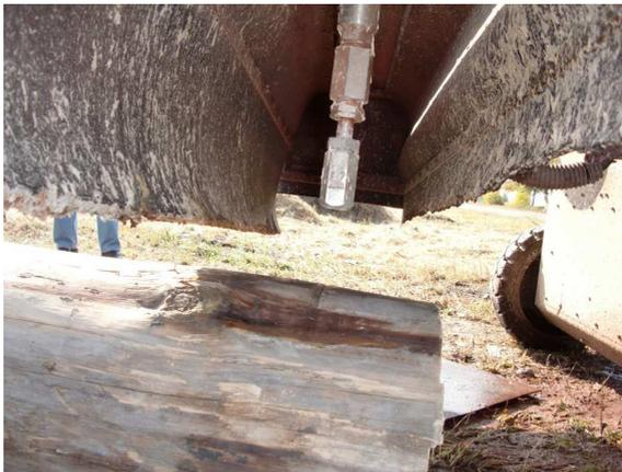
Abbildung 1: 2500 bar Hochdruckdüse vor dem Schnitt
