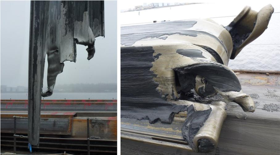
Abbildung 6: Im Pfahlfußbereich zur Hälfte abgerissene Doppelpundbohle (links),
