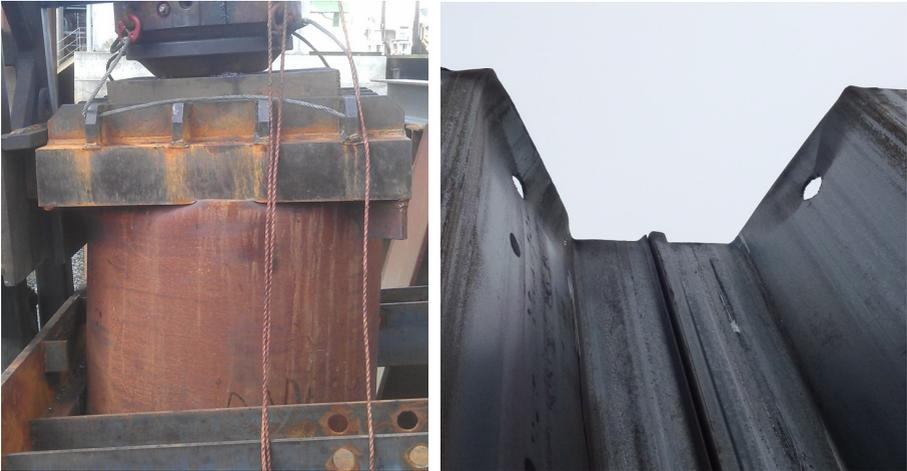
Abbildung 5: Pfahlkopfverformung infolge zu kleiner Schlagplatte am Rohrpfahl (links), Pfahlkopfverformung infolge zu kleiner Schlagplatte Doppelspundbohle (rechts)
