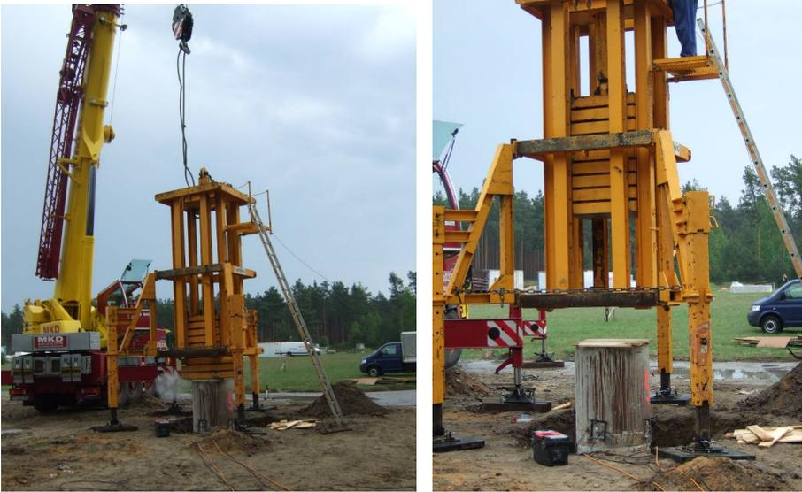
Abbildung 12: Dynamische Probelastungen
