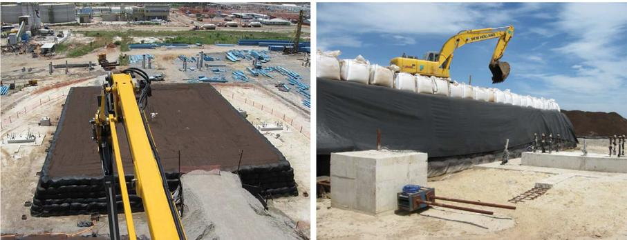
Abbildung 8: links: Feldversuch zur Seitendruckbeanspruchung; rechts: Testfundamente
