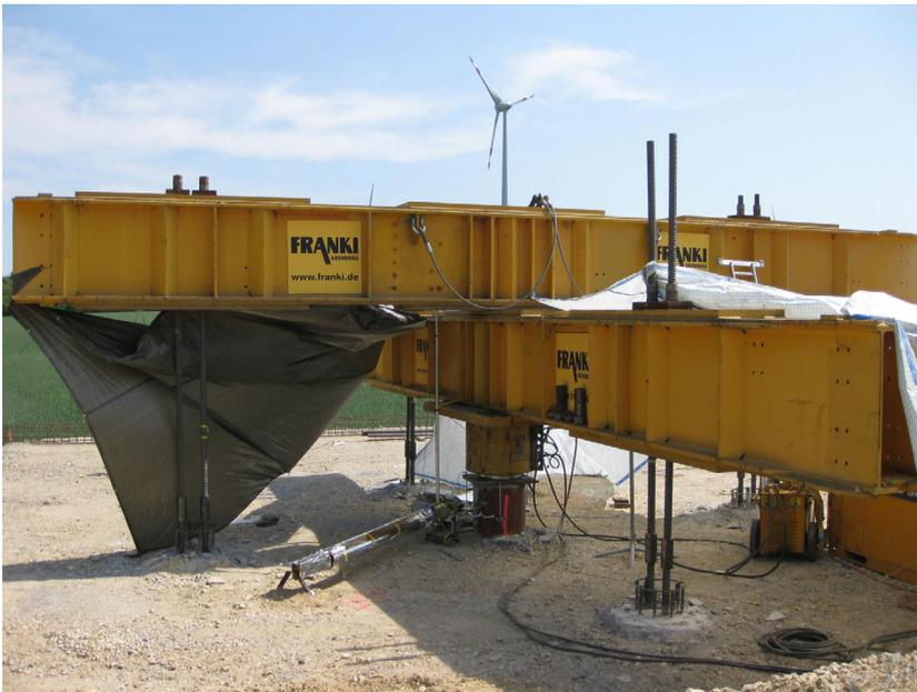
Bild 14: Aufbau der Probelastung P1
