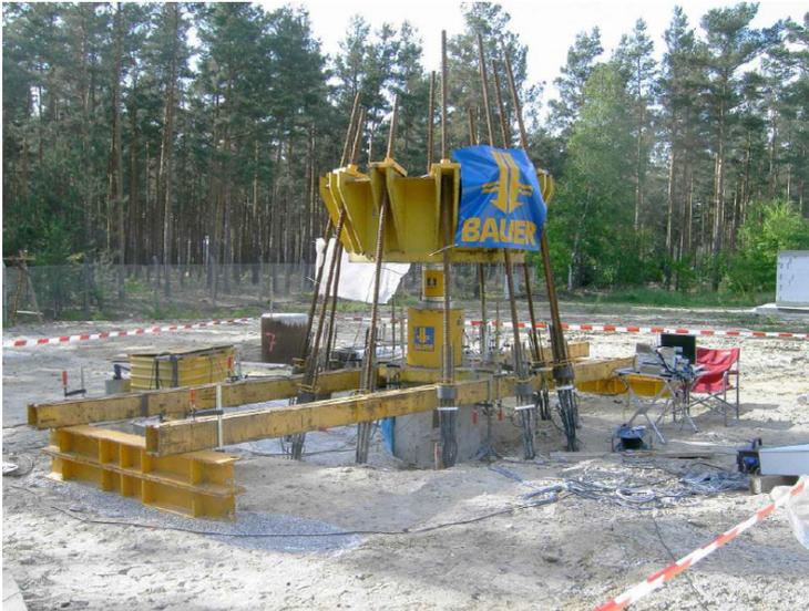
Abbildung 8: Statische Pfahlprobelastung
