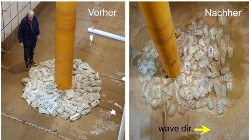
Abbildung 7: Großmaßstäbliche Modellversuche zum geotextilen Kolksschutz am Monopile,
