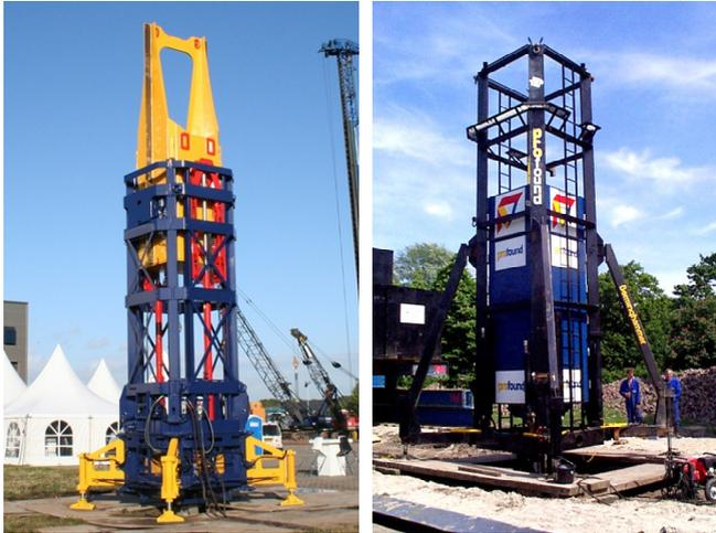
Abbildung 2: Belastungseinrichtung StatRapid®, links und Statnamic®, rechts
