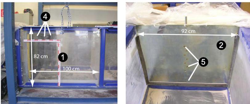
Bild.1 Seiten- und Innenansicht des Versuchskastens
