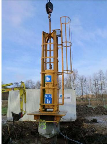
Abbildung 14: Fallgewicht für dynamische Probelastungen.
