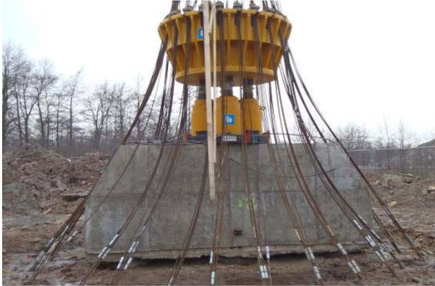
Abbildung 8: Kopfbalken und Belastungskrone Pfahlgruppe (nach Versuchsende).
