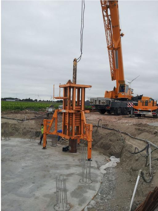
Bild 3: Durchführung der dynamischen Probelastung
