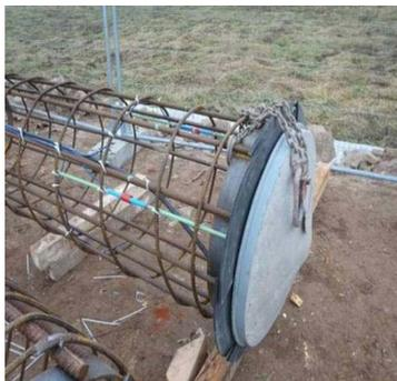
Abbildung 6: Druckmessdose und Dehnungsaufnehmer.
