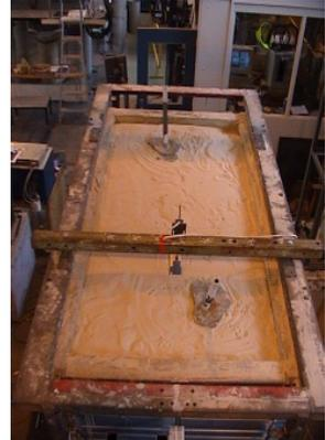
Abbildungen 13, 14, 15: Versuchsaufbau Bodenverflüssigung mit einem und zwei Verpresspfählen TITAN
