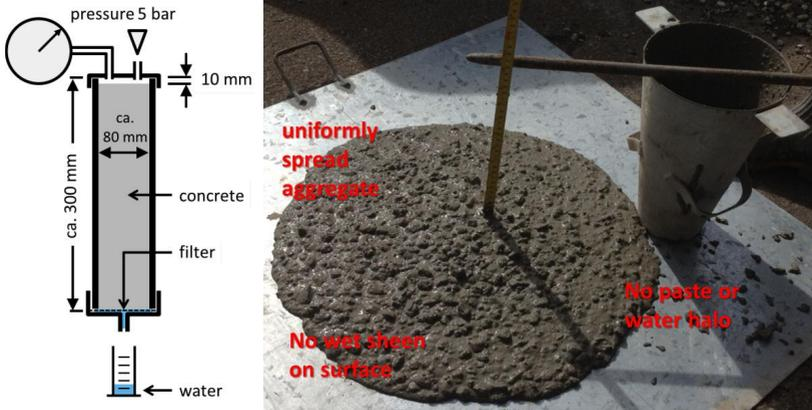
Abbildung 7: Der „BAUER filtration test“ (links) und die Beurteilung der Frischbetonstabilität gegen Sedimentieren gemäß dem „VSI test“ (rechts)
