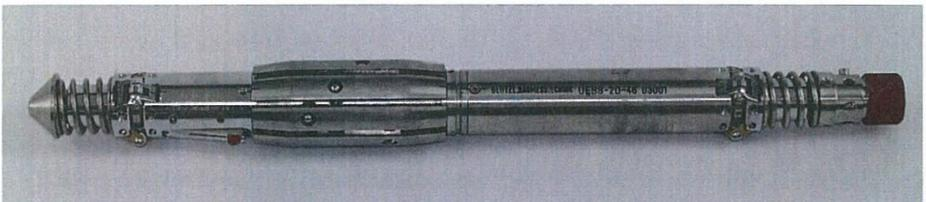
Abb. 6: Neue BGR-Überbohrsonde Mk VII (Hersteller: Glötzl)
