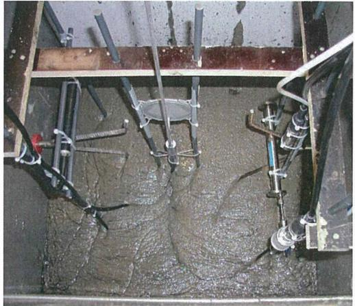
Bild 7:        Versuchsstand vor und während des Einbaus von Salzbeton
