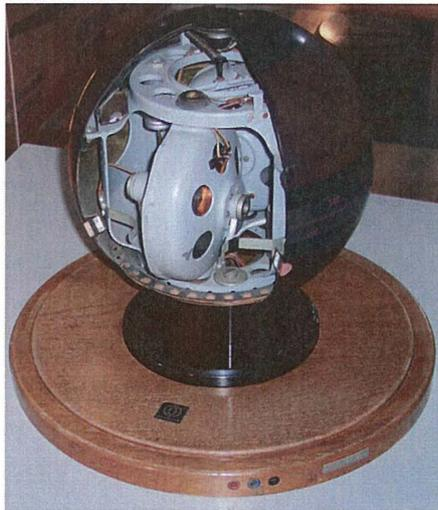
**Abbildung 7: 3-fach Gyroskop (Kugelgyroskop) der Fa Anschütz**
