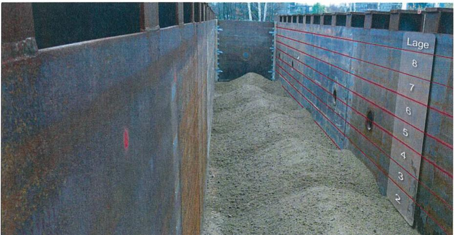
Abbildung 7: Einbau eines erdfeuchten Versuchsbodens
