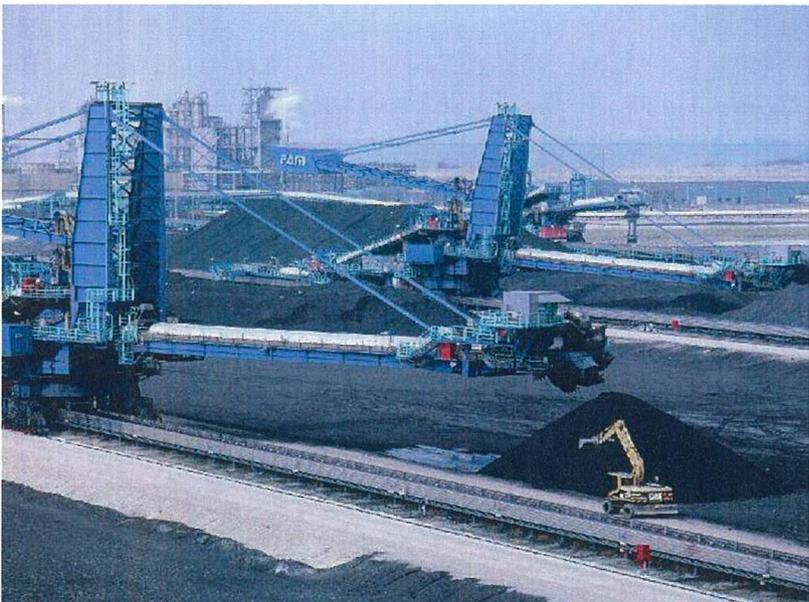
**Bild 1** Erzlager mit Stacker/Reclaimer (Europoort Rotterdam)
