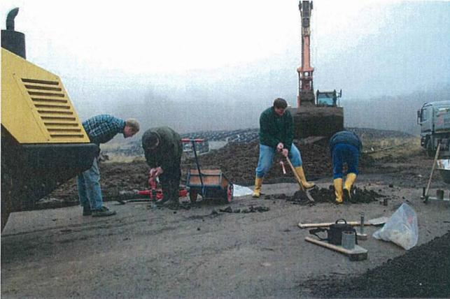
Bild 1 Konventionelle Beprobung einer Deponieabdichtung mit Stechzylindern
