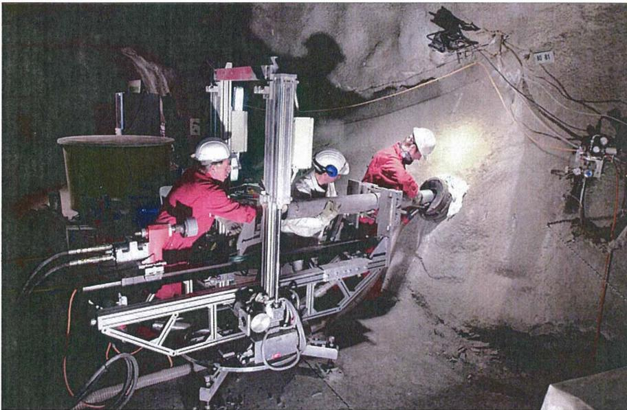
Abb. 4: DI-Messlokation mit der speziell für Überbohrversuche konstruierten BGR-Bohrmaschine
