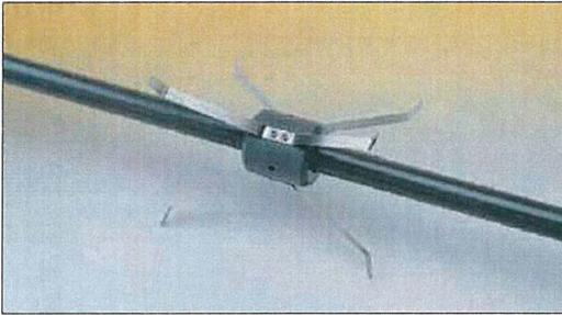
**Bild 14** Extensometer mit magnetischen Ankerpunkten zur Messung großer relativer Vertikalverschiebungen
