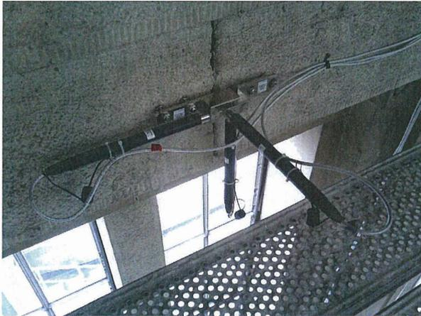
Die durch die Vereisung notwendige Überwachung der Gebäudetemperatur erforderte Sensoren in der Bodenplatte und den Wänden, die ebenfalls ihre Daten über das Netz aus Mess- und Stationsbus an die Messzentrale übermitteln.
