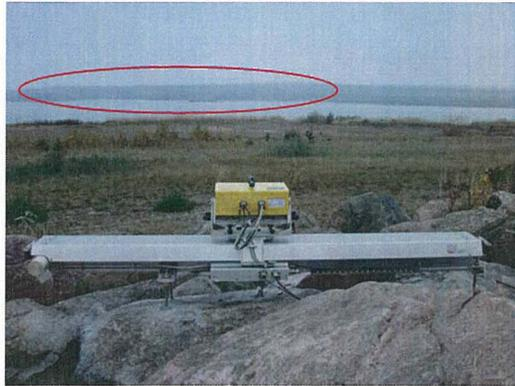
Abb. 6: Das IDS GBSAR-Messsystem im Tagebaurestloch Greifenhain, innerhalb der roten Ellipse befindet sich der instabile Böschungsabschnitt.
