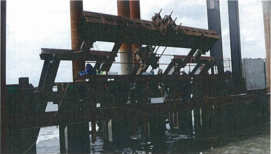
Abb. 12: Statischer Zugversuch an einem Schräganker am JadeWeserPort
