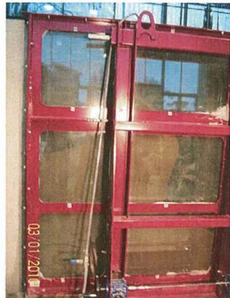
Bild 6: großmaßstäbliches Kluftmodell (rechts: Injektionsversuch)
