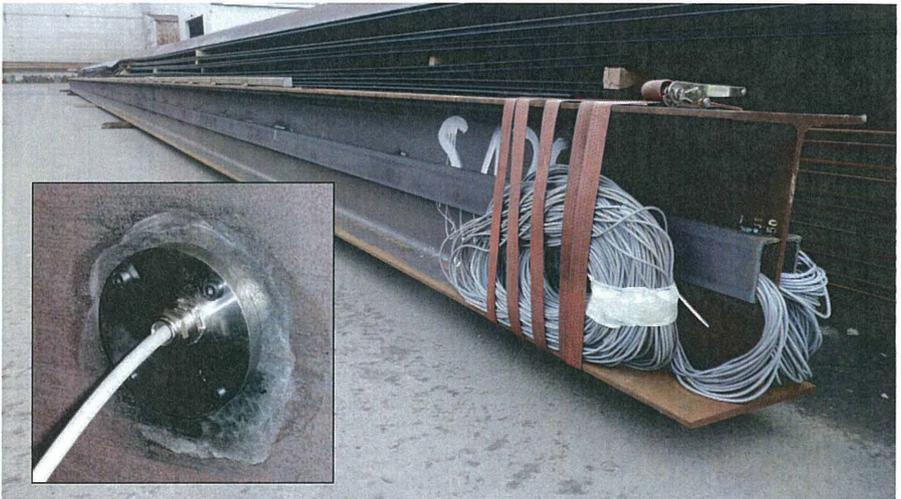
Abb. 11: Fertig applizierter Messgeber und zum Transport bereiterr Schräganker für den JadeWeserPort
