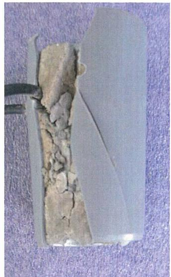
Bild 3: Spannungsgeber im Prüfkörper
