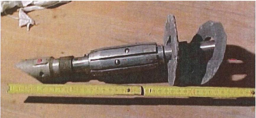
Abb. 5: Alte BGR-Überbohrsonde Mk IV (Hersteller: Stitz)
