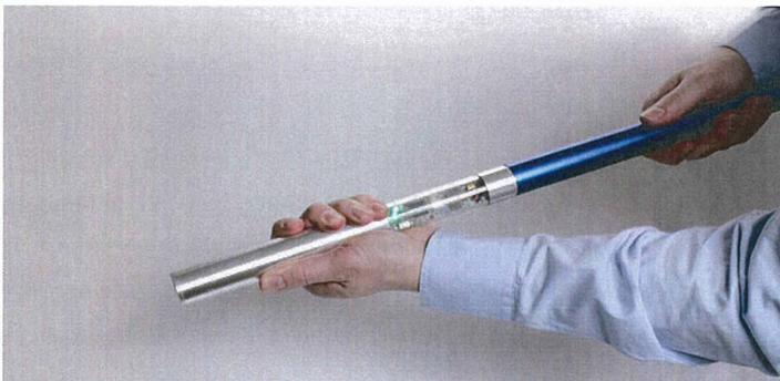
**Abbildung 13: Außenabmessungen des REFLEX GYRO (32 mm Außen-Ø)**
