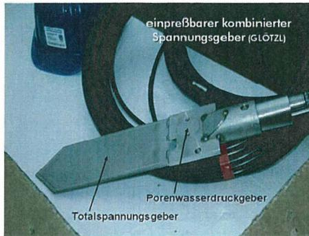
Abb. 5: Einpressbarer kombinierter Spannungsgeber
