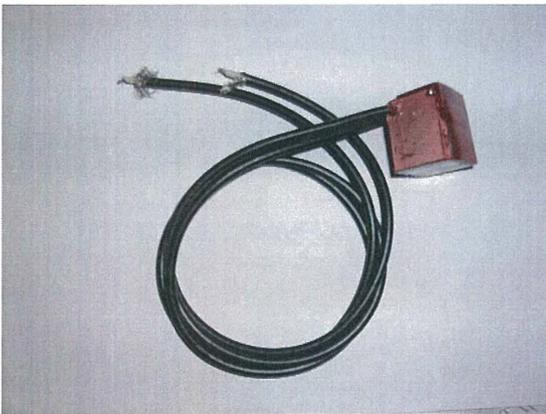
Bild 2: 2-Axialer Spannungsgeber (25 mm) für Beton-einschluss
