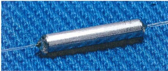
Abb. 5: Faser mit verklebter Metallhülse (zum Größenvergleich: die Faser hat einen Außendurchmesser von  $195\ \mu\text{m}$ )
