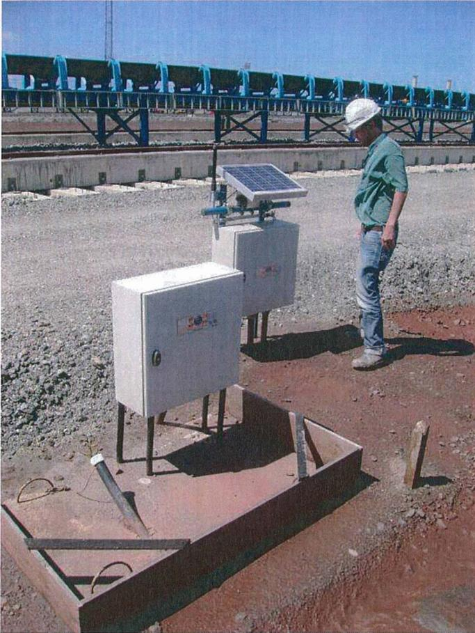
**Bild 17** Settlement-Profilier Endplatte und Festpunkt mit Ausgleichsbehälter für Setzungsmesspunkte (links) sowie Datenlogger mit autarker Stromversorgung über Solarzellen und Funkmodul
